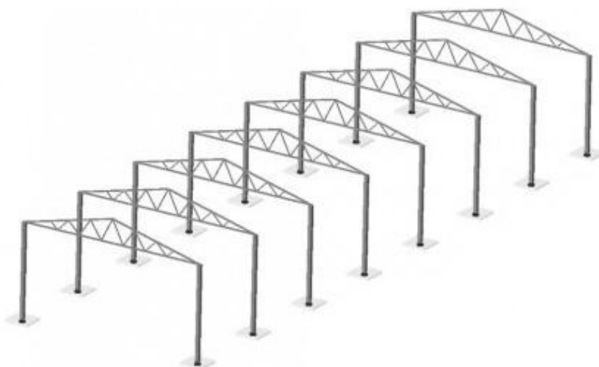
Слика 1.3 – Кровна конструкција изведена са раванском решетком
