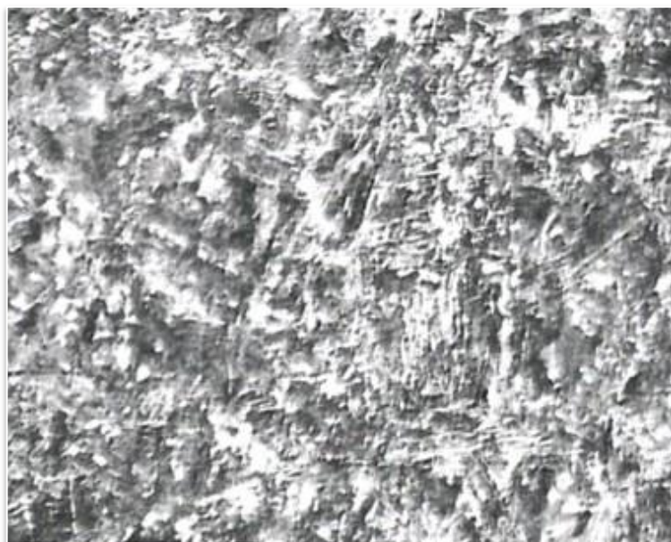
Структура игличастог мартензита, увећање 200×
