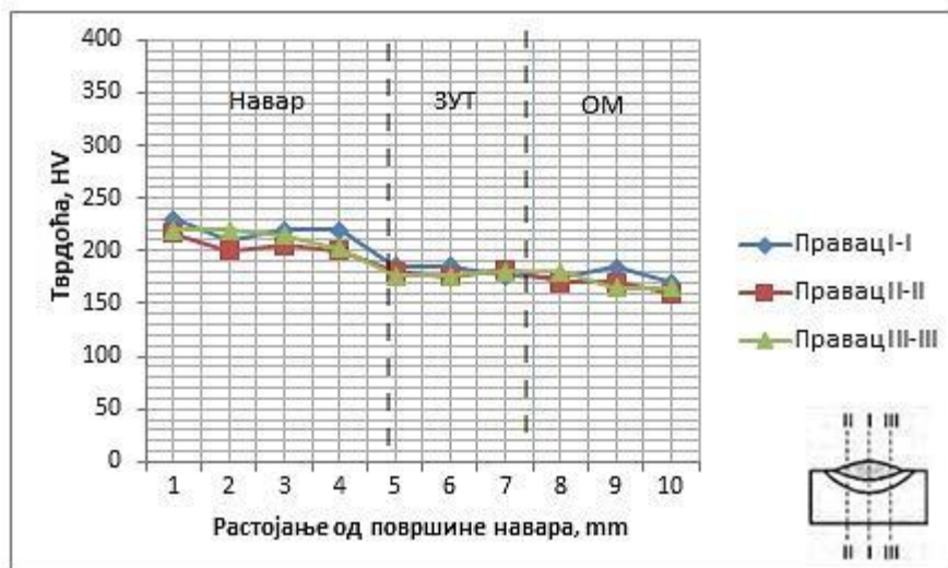
Слика 5.13 Расподела тврдоће по пресеку двослојног навара: а) О.М.-S355J2G3, Д.М. навара – VAC60
