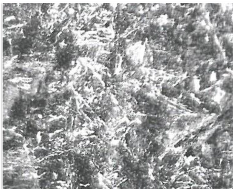
Структура игличастог мартензита, увећање 200×
