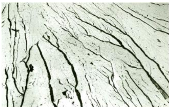
Слика 3.24 Крти и жилави лом под електронским микроскопом 1000×
