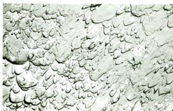
Слика 3.24 Крти и жилави лом под електронским микроскопом 1000×
