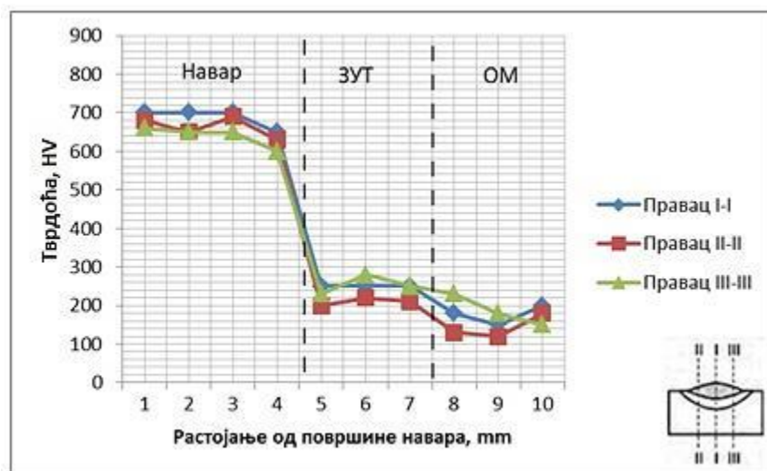
Слика 5.8 Расподела тврдоће по пресеку двослојног наvara: а) О.М.-S235JR, Д.М. наvara - FILTUB DUR 16
