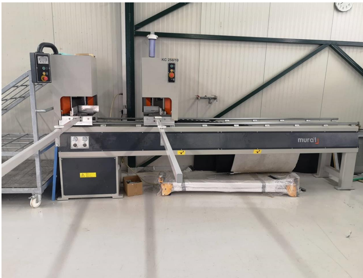
Слика 20. Варилица за ПВЦ профиле - “Murat KC 258”
