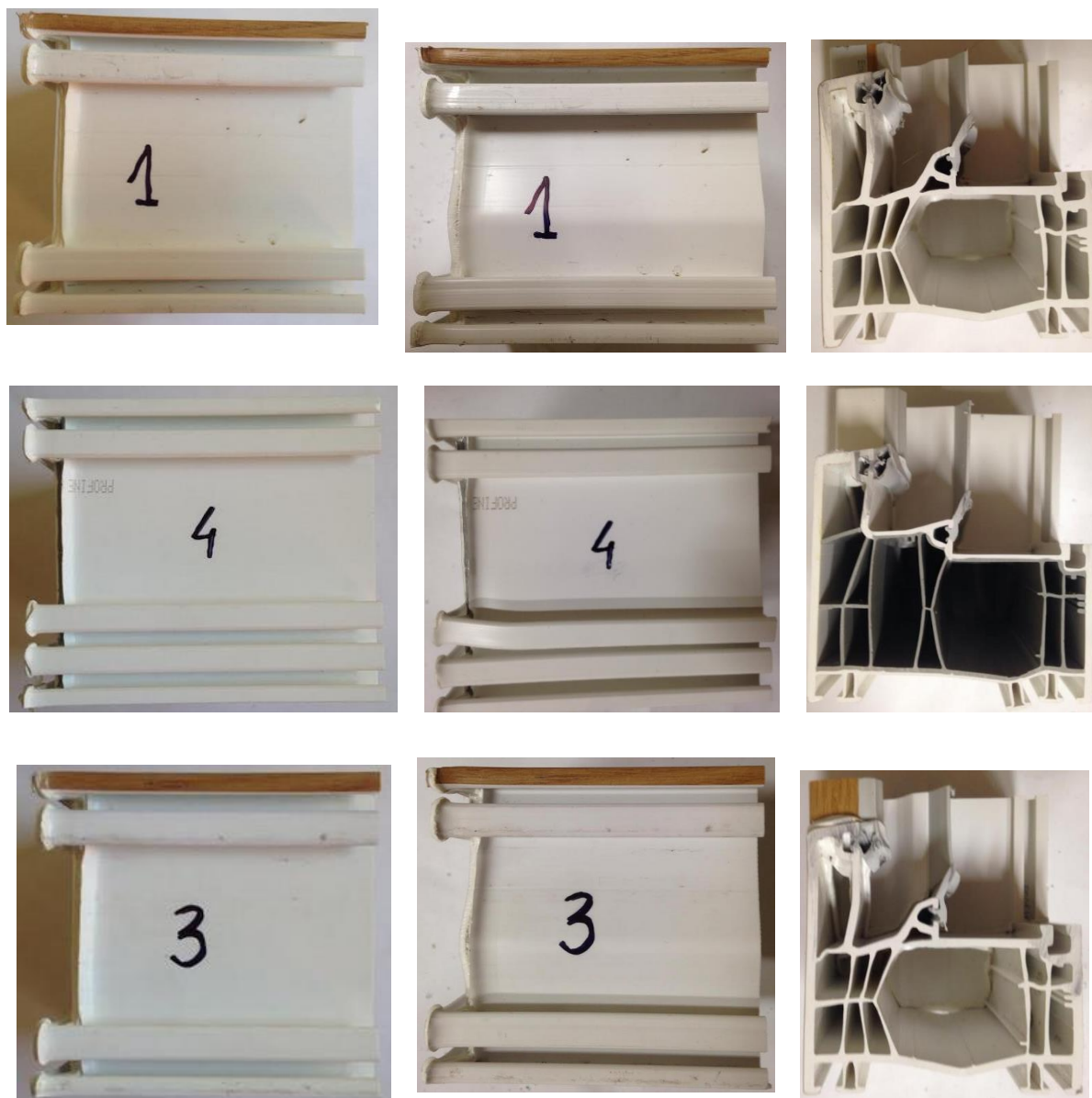
Слика 33. Узорци 1, 4 и 3 пре и после притискивања силом од 5 t
