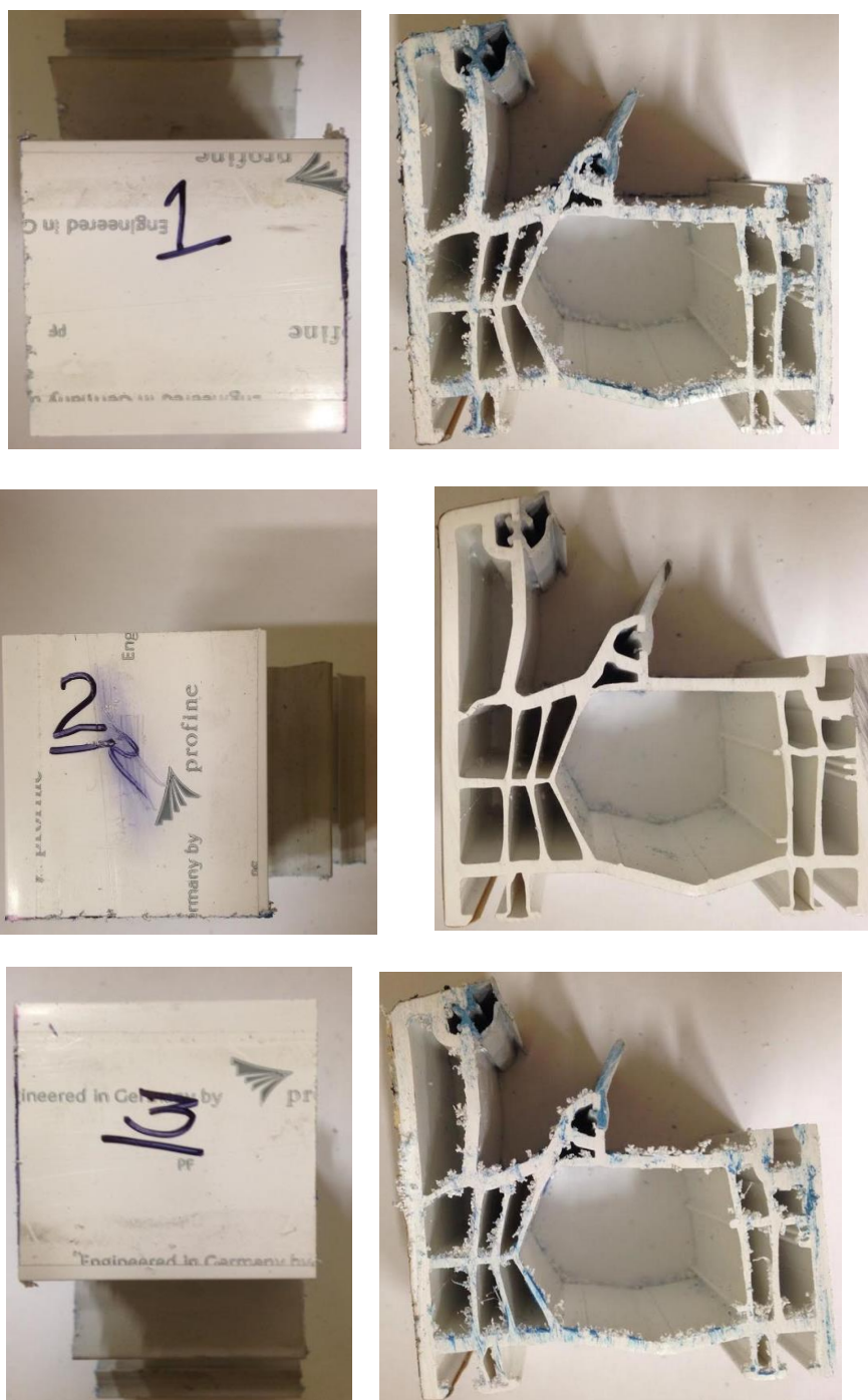
Слика 31. Узорци 1, 2 и 3 пре и после притискивања силом од 2 t
