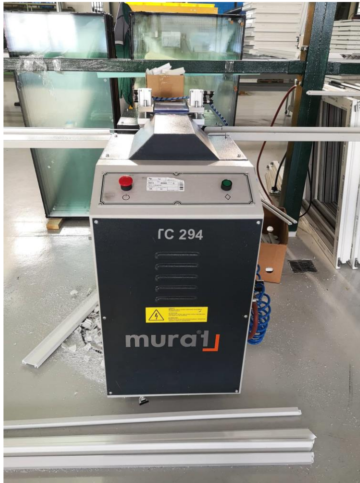
Слика 22. Машина за сечење лајсни - “Murat TC 294”
