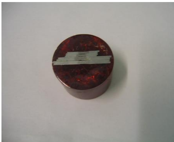
Слика 6.15 Изглед затопљених металографских избрусака
