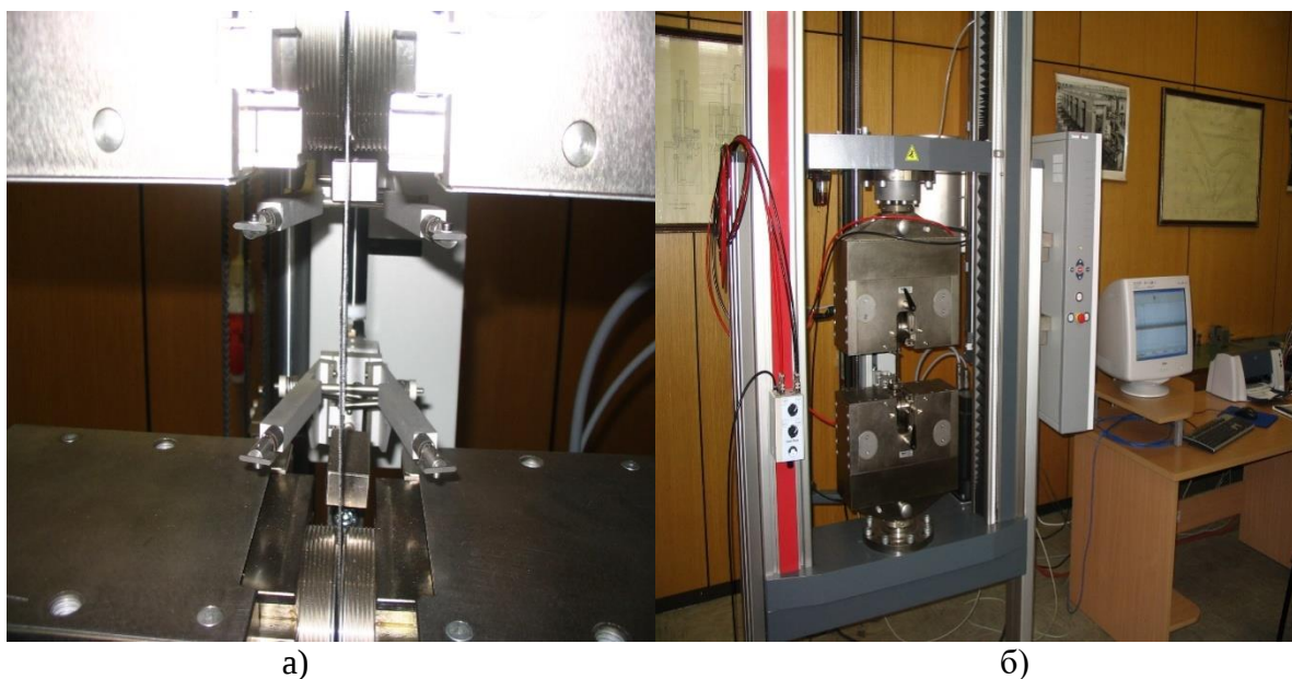
Слика 6.5 Изглед савременог мерног система (Zwick/Roell Z100): а) изглед екстензометара и б) детаљ стезних чељусти
