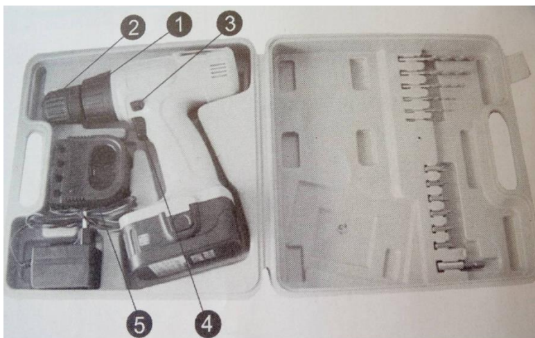
Слика 3.11 Садржај испоруке; 1 – регулациони прстен, 2 – стезна глава, 3 – прекидач за стални рад, 4 – прекидач за укључење, 5 – пуњач батерије.
