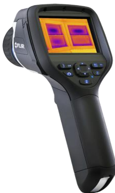
Слика 5.4 Термовизијска камера FLIR E50
