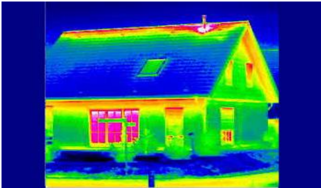
Слика 4.4 Примена термовизијске камере у грађевинарству
