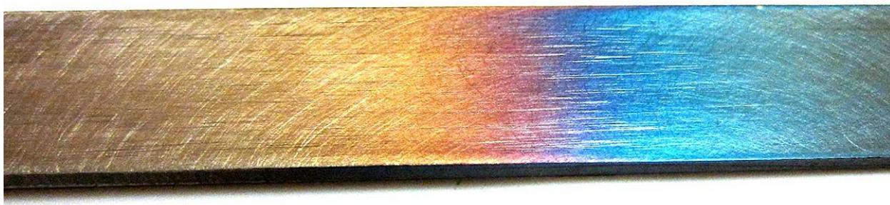
Слика 3.5 промена боје металног оксида услед повећања температуре
