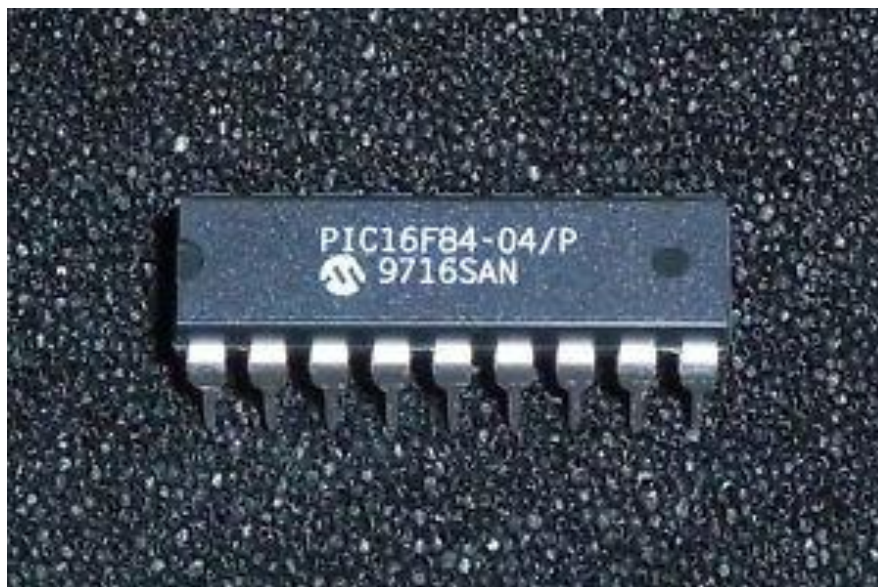
Слика 1: Изглед микроконтролера PIC16F84 [4]
