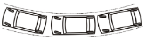
Слика 4. Неутрална управљивост \delta_p = \delta_z по кривини одговарајућег полупречника [4]
