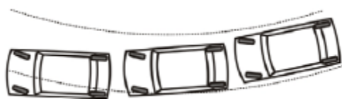
Слика 5. Подуправљивост \delta_p > \delta_z по кривини већег полупречника ("блажој") [4]
