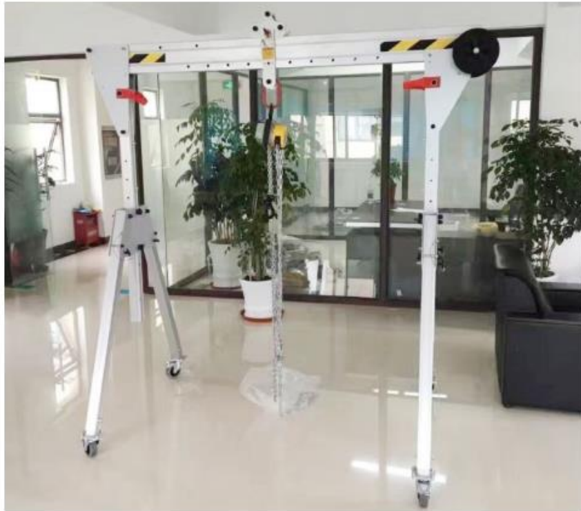
Слика 3.7 Лака портална дизалица конструисана од алуминијума [6]
