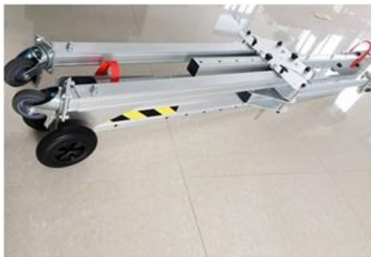
Слика 3.8 Склопљена лака портална дизалица конструисана од алуминијума [6]
