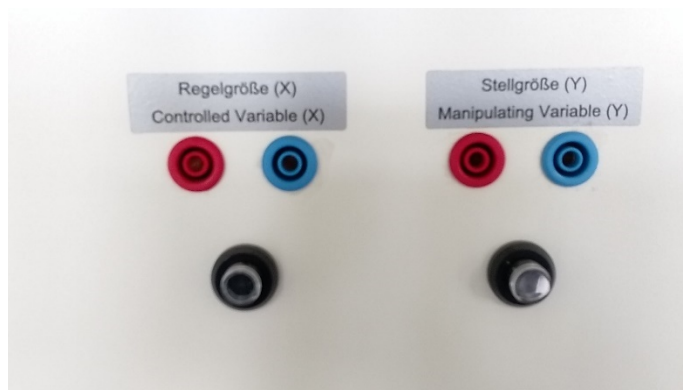
Слика 19. Приказ излаза сигнала у електричном облику
