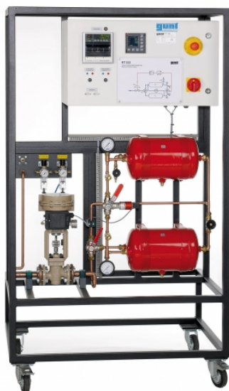
Слика 8. Реални приказ система G.U.N.T. TrainerPressureControlRT532 као пример идентификације [26]
