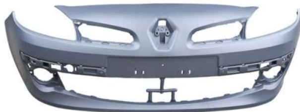
Слика 6.59 Алуминијумски браник аутомобила RenaultClio III
