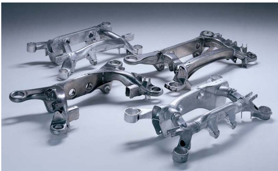
Слика 6.14 Алуминијумска задња осовина произведена од AlMgMn лимова алуминијумских легура
