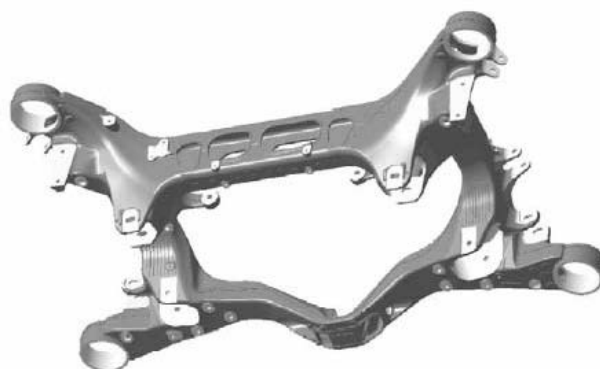
Слика 6.13 Задња осовина подрама Porsche Panamera шупљо ливена као једноделна под ниским притиском, произведена од стране VRC/ PRC технологије
