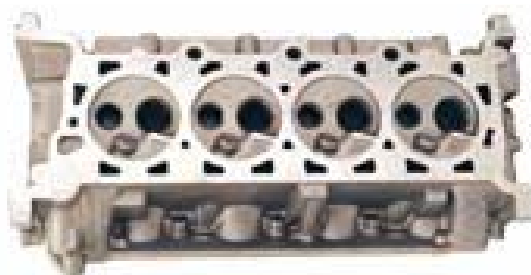
Слика 6.39 Алуминијумска глава четворотактног мотора
