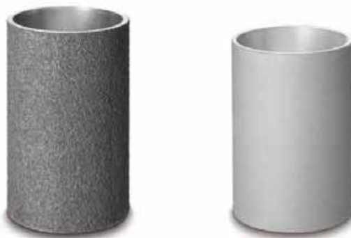
Слика 6.33 Облоге од сивог лива а са грубим спољним површинама користећи директно ливену површину (лево) или накнадну површинску обраду (десно) обезбеђује боље механичко везивање.
