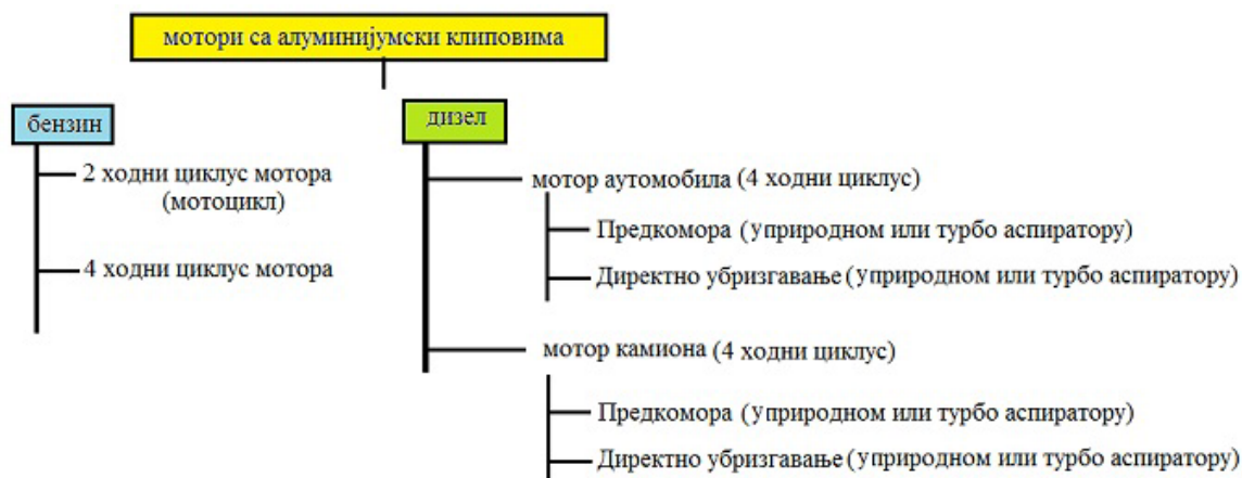
Слика 6.26 Разни мотори са унутрашњим сагоревањем са алуминијумским клиповима
