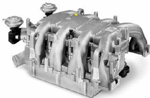
Слика 6.58 Усисна грана са интегрисаним ваздушним хладњаком - Audi 8 цилиндара ТДИ (алуминијумски хибрид дизајн произведен ливењем под високим притиском)
