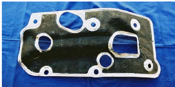
Слика 6.49 Топлотна изолација са вискоеластичним слојем која апсорбује звук
