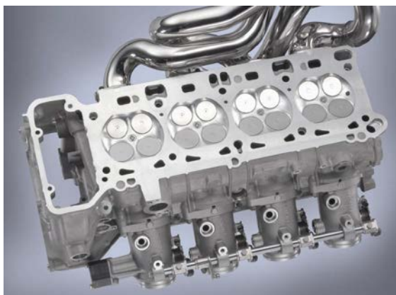
Слика 6.40 Глава мотора са индивидуалним пригушним телом и издувном граном
