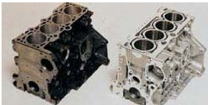
Слика 6.30 Сиви лив и алуминијум HPDC блок мотора
