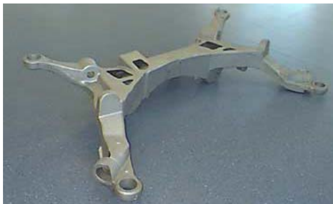
Слика 6.12 Задња осовина подрама шупљо ливена као једноделна, произведена од стране VRC/ PRC технологије
