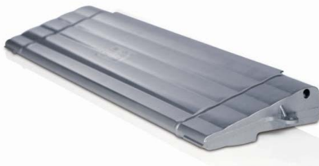
Слика 6.8 Ваздушна ћелија за систем ваздушног вешања код Ауди А6 (SAG Motion AG)
