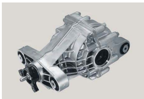
Слика 6.62 Кућиште диференцијала направљено ливењем под притиском од легуре алуминијума
