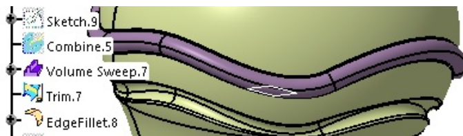
Слика 1.41.- Дефинисање моделских форми Volume Sweep.7 , Trim.7 и Edge Fillet.8
