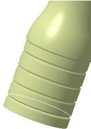
Слика 2.11.- Дефинисање моделских форми RectPattern.1 , Trim.2 и Edge Fillet.3
