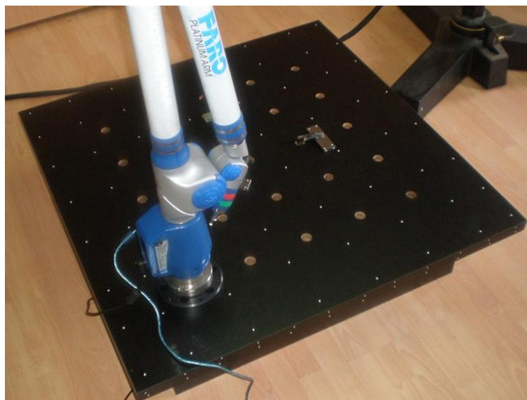
Слика 4.2: Мерни сто са некодираним референтним тачкама
