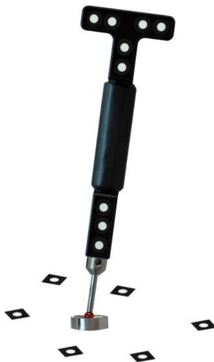
Слика 3.1.1: Алат за калибрацију са референтним тачкама
