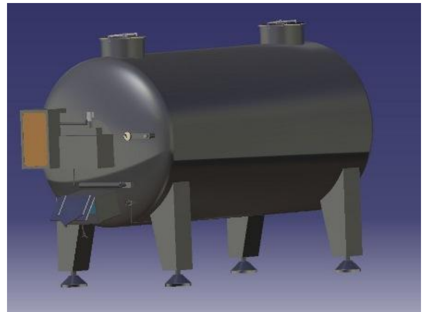
Слика 11. Шема и 3Д модел винификатора
