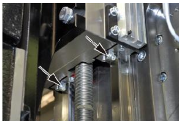
Слика 13. Тачке подмазивања на јединици за бушење [3]
