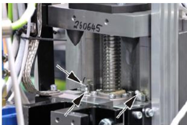
Слика 13. Тачке подмазивања на јединици за бушење [3]
