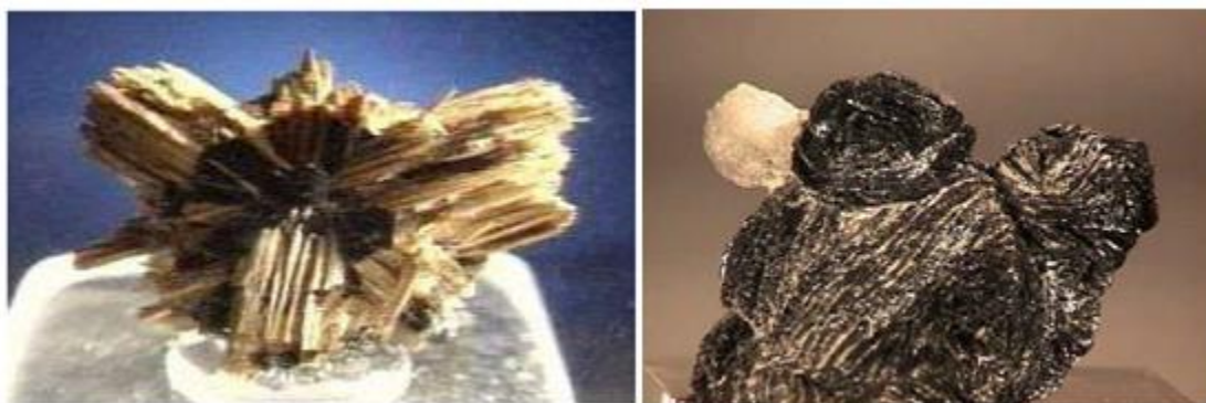
Слика 4.7 Изглед минерала рутила \text{TiO}_2 –лево, изглед минерала илменита \text{FeTiO}_3 -десно [28]
