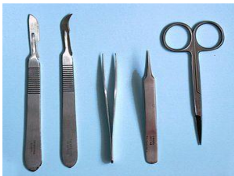
Слика 4.3 Хирушки прибор од мартензитног челика [12]
