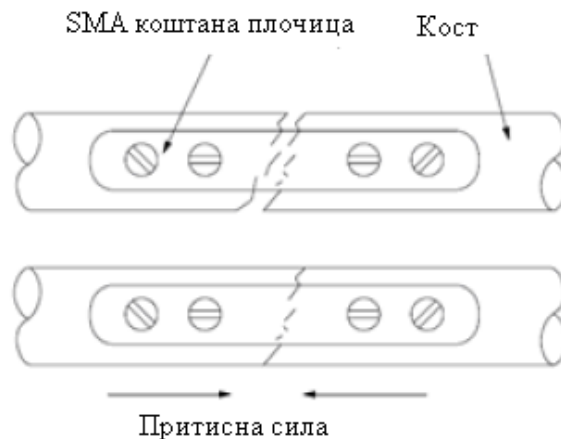
Слика 3.18 Фиксација кости помоћу SMA [12]
