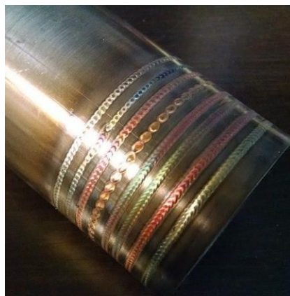
Слика 4.6 Примери тврдог наваривања са применом различитих параметара [26]
