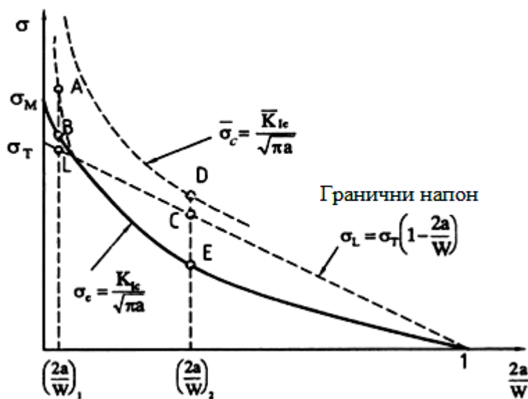
Слика 2.12 - Дијаграм преостале чврстоће за крт и дуктилан материјал
