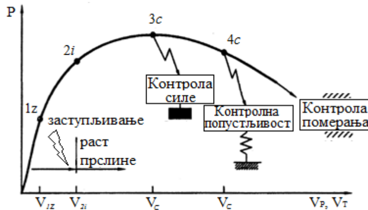
Слика 3.5 - Зависност сила - померање ( P-V_p ) при контроли силе, P , контроли укупног удаљеног померања, V_T , и контроли локалног померања, V_p
