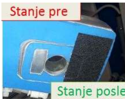
Слика 9 – Стање пре облагања и након облагања заштитном траком
