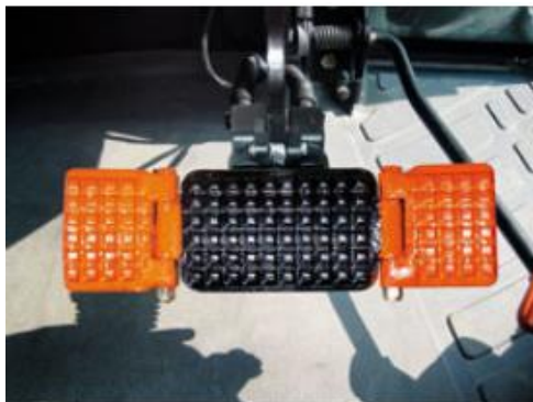
Слика 65. Управљач кормила помоћу ABS SuperSteera у NevHolland-у ће управљати продужавањем на педалу једне кочице [2]
