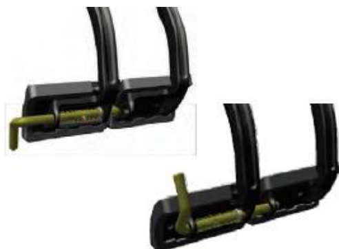
Слика 32. Раздвајање и спајање педала кочница [5]
