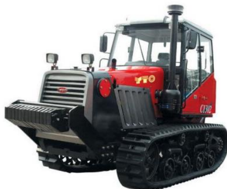
Слика 25. Шема трактора с еластичном гусеницом [3]
