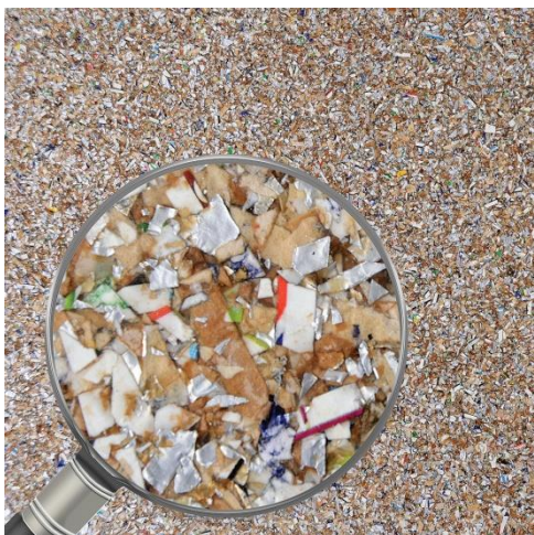
Слика 14. Водоотпорне еко-плоче које се састоје од пресованих делића рециклираног тетрапака (Фепло, 2020)
