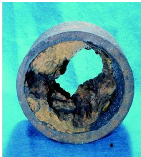
Слика 11: Растварање Fe при селективној корозији [11]
