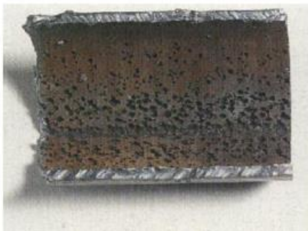
Слика 17: Пример кавитационе корозије [7]
