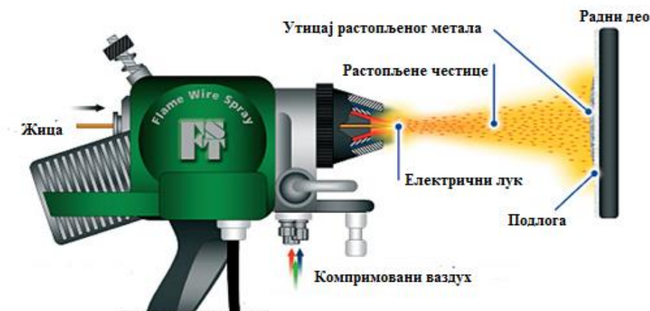
Слика 35: Приказ пиштоља за метализацију [18]
