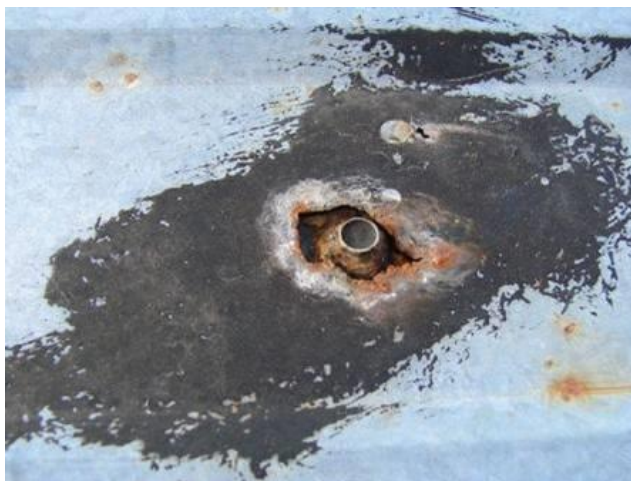
Слика 14: Пример корозије у зазорима [12]
