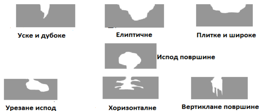
Слика 9: Различити облици јамица на попречном пресеку [10]
