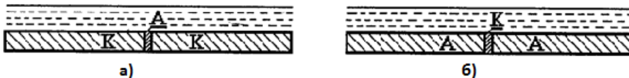
Слика 25: Лоше (а) и добро (б) решење спајања метала заваривањем; А – анодни део површине и К – катодни део површине [1]
