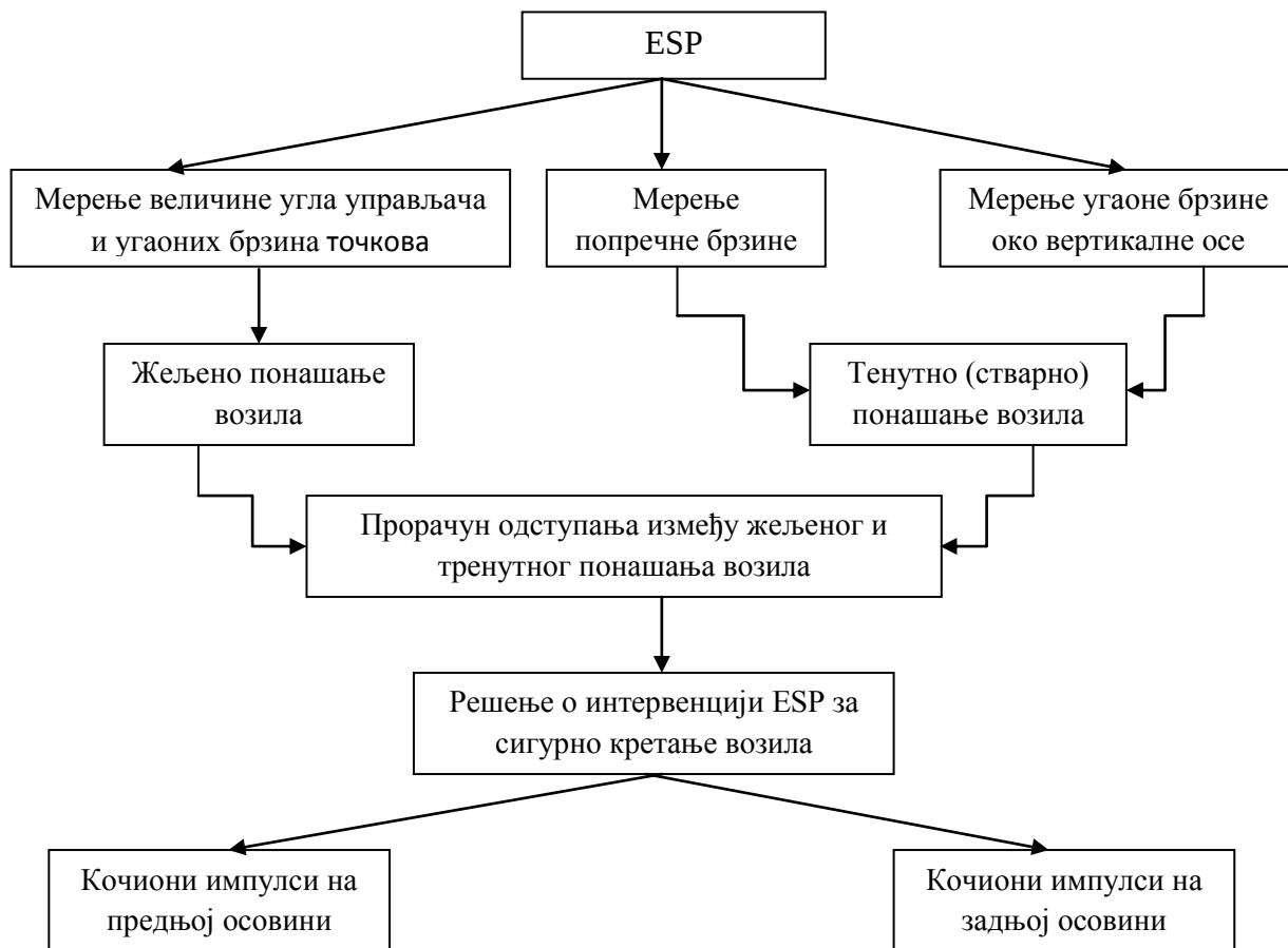
Слика 27.Шема рада ESP-а
