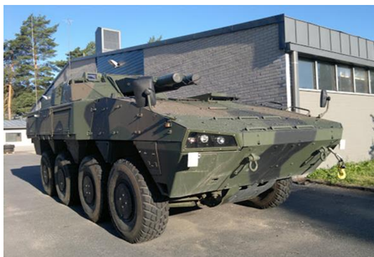
Слика 1.11 Минобацач 120 mm AMOS интегрисан на возило Patria AMV [10]
