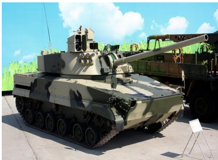
Слика 1.9 Самоходни топ / минобацач 120 mm 2С31 – Вена [8]
