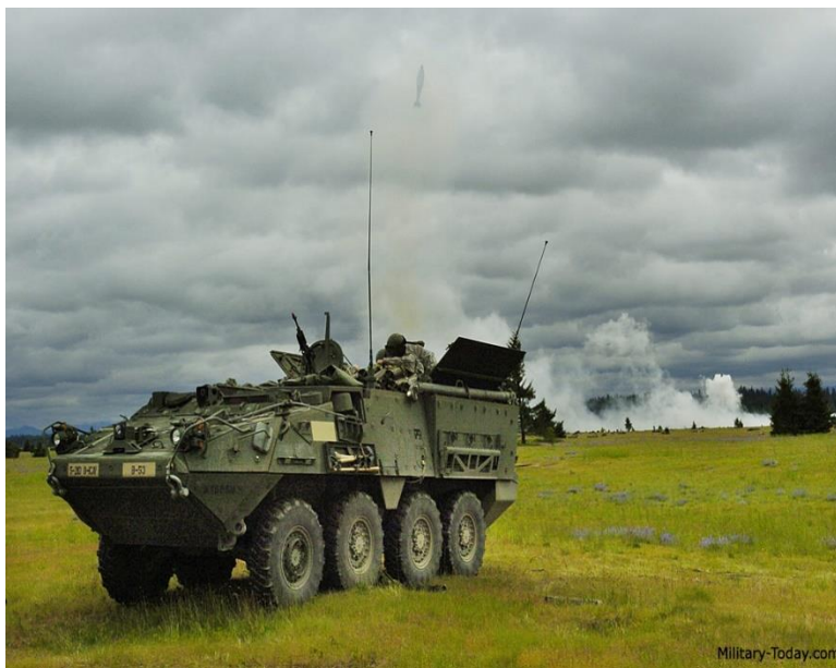
Слика 1.12 Самоходни минобацач 120 mm M1129 Stryker [11]
