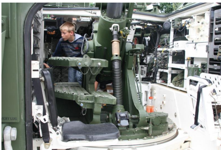
Слика 1.13 Унутрашњост самоходног минобацача 120 mm M1129 Stryker [11]
