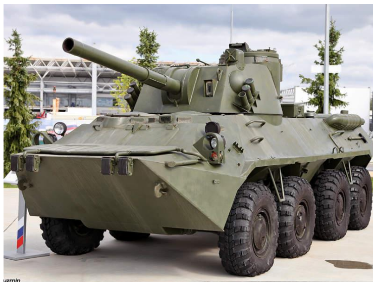
Слика 1.8 Самоходни минобацач 120 mm 2С23 – Нона СВК [7]
