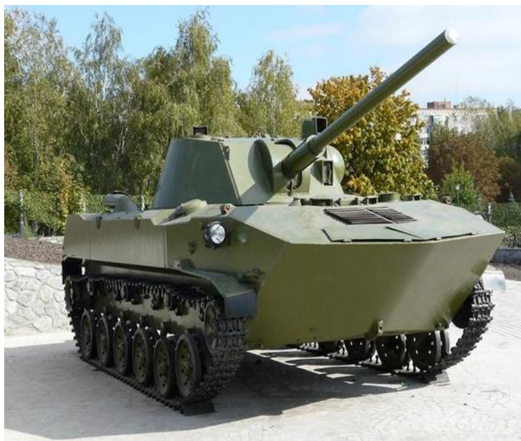
Слика 1.7 Самоходни минобацач 120 mm 2С9 Нона – С [6]
