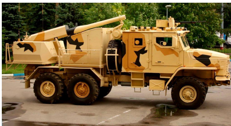
Слика 1.14 Самоходни минобацач 120 mm Флокс [13]
