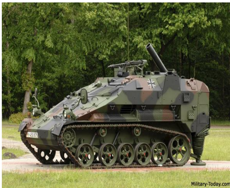
Слика 1.10 Самоходни минобацач 120 mm Wiesel 2 [9]
