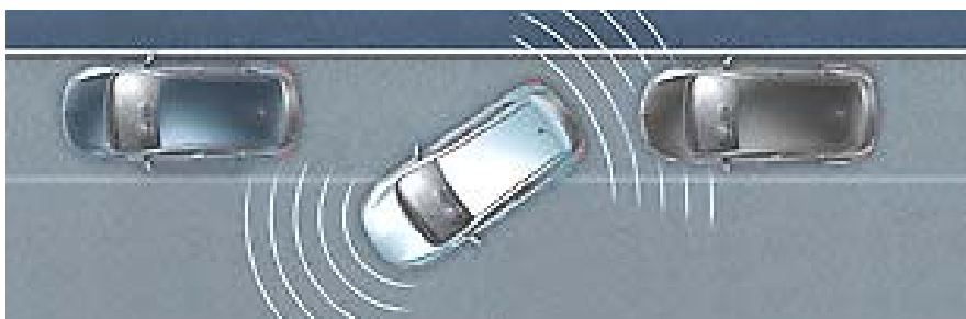
Слика 55. Помоћ при паркирању паркинг сензори [22]
