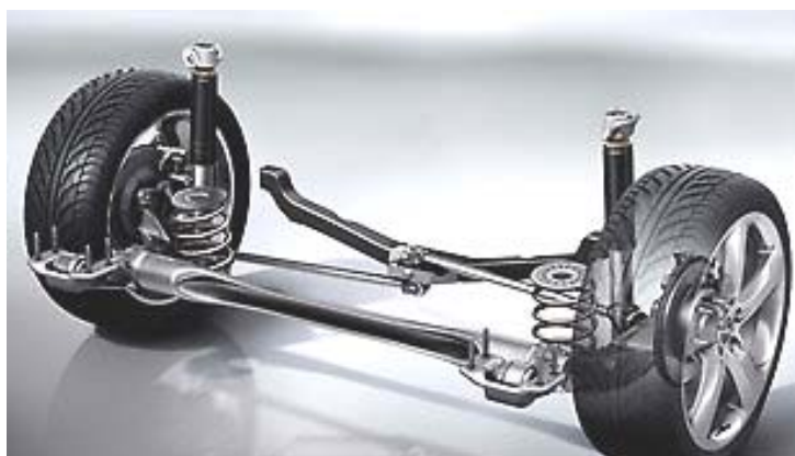
Слика 63. Watt споне Опел Астре ефективно спречавају било какво бочно осовинско померање, при чему обезбеђује удобнију вожњу и боље управљање и доприносе бољем управљању и стабилности [20]
