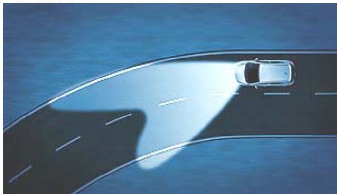
Слика 59. Прилагодљиво предње осветљење код нове Астре - AFL значајно повећава видљивост [20]
