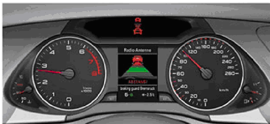
Слика 52. Звучно упозорење и трепћуће црвено упозорење на инструмент-табли система Audi braking guard [10]
