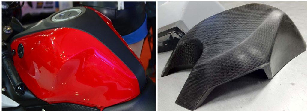
Слика 15. Лево - алуминијумски резервоар за гориво мотоцикла Yamaha R3, десно - резервоар за гориво израђен од угљеничних влакана
