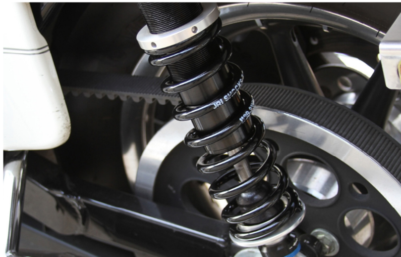
Слика 23. Каиш као преносник обртног момента на погонски точак
