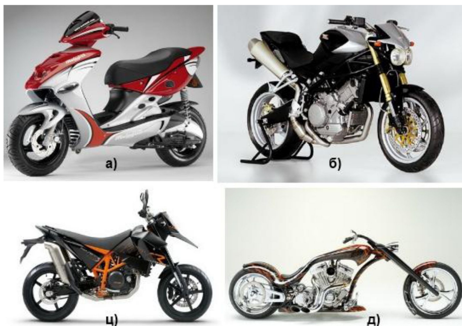
Слика 6. Врсте мотоцикала: а) Скутер, б) Naked мотоцикл, ц) Supermoto мотоцикл, д) Чопер мотоцикл
