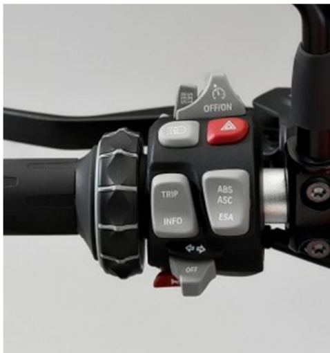
Слика 18. Пример команди система за повећање стабилности (ABS, ASC, ESA итд.) и команде путног компјутера
