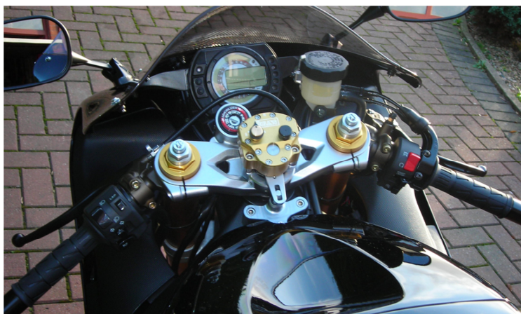
Слика 17. Типичан пример управљача мотоцикла са командама
