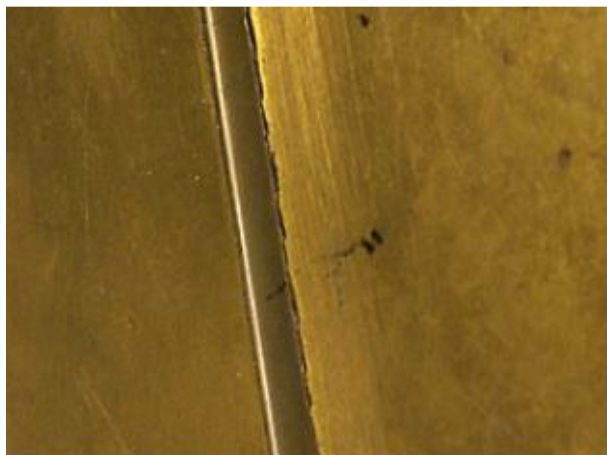
Слика 6.1 Спајање истих материјала FSW поступком – месинг [10]
