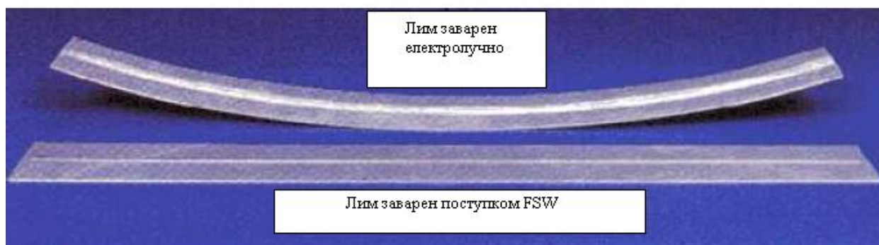
Слика 3.15 Лимови заварени електролучно и поступком FSW [8]
