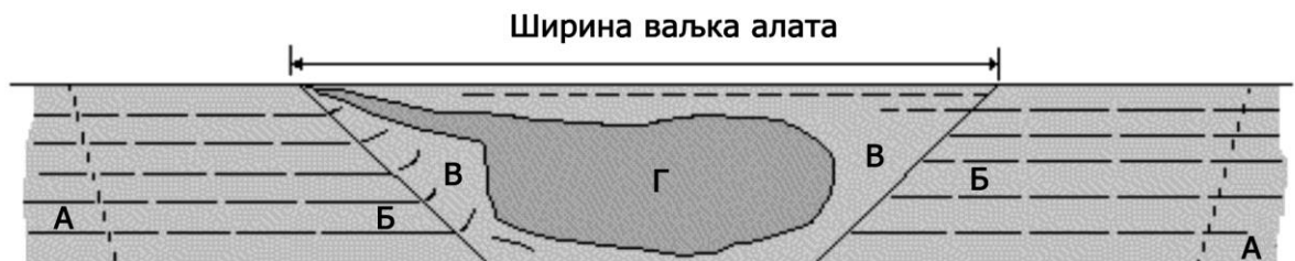
Слика 3.10 Распоред појединих зона у завареном споју добијеном процесом FSW (А – Основни материјал (ОМ); Б – Зона утицаја топлоте (Heat Affect Zone - HAZ); В – Зона термо-механичког утицаја (Thermo-Mechanically Affect Zone - TMAZ); Г – Зона мешања (Stirred Zone) или "грумен" зона (Nugget Zone – NZ)) [1]
