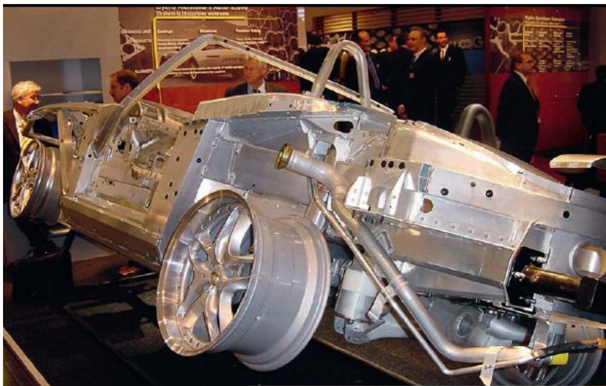
Слика 7.7 Елементи аутомобила израђени од алуминијума FSW поступком [10]
