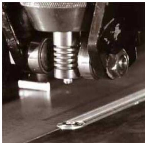
Слика 4.5 Систем за контролу дубине продирања чела алата у материјал који се састоји од два помоћна ваљка [9]
