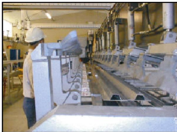
Слика 7.1 Спајање монтажних, алуминијумских плоча поступком FSW, у производњи бродова [1]
