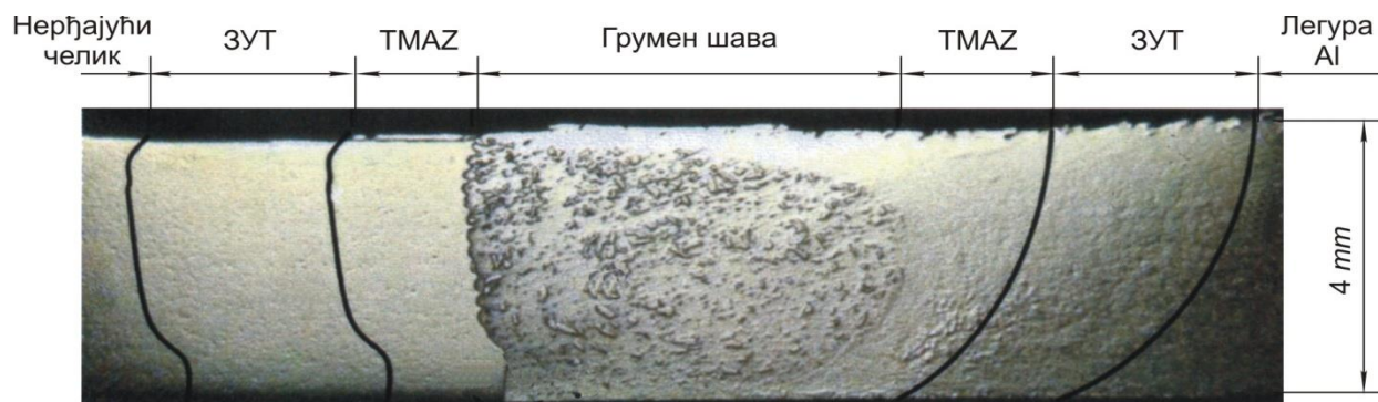
Слика 6.4 Макроскопски изглед пресека FSW споја легуре Al 6013-T4 и нерђајућег челика X5CrNi18-10 [6]
