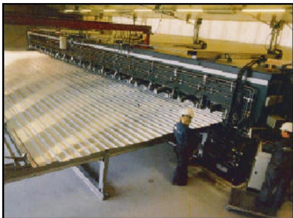
Слика 7.1 Спајање монтажних, алуминијумских плоча поступком FSW, у производњи бродова [1]
