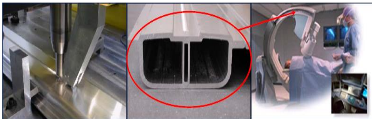
Слика 7.11 Делови за скенер направљени FSW поступком [10]
