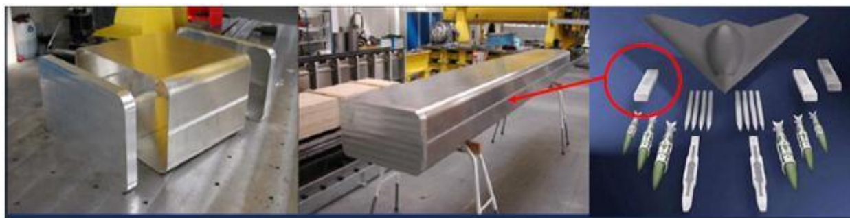
Слика 7.6 Употреба FSW при изради резервоара за беспилотне летелице [10]
