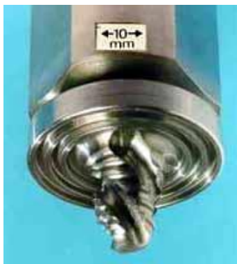
Слика 5.2 Мулти спирални алат за FSW [1]
