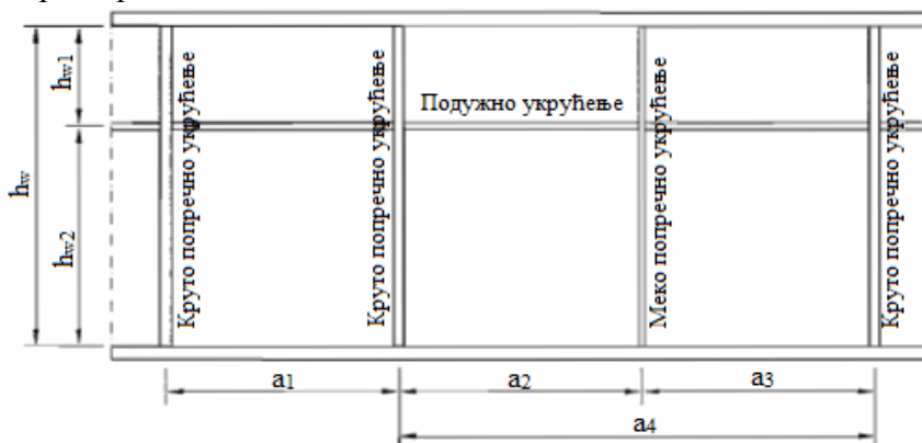
Слика 4.10 - Ребро са попречним и подужним укрућењима [8]
