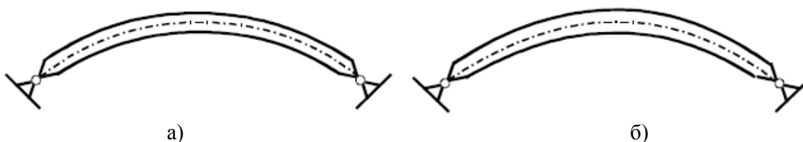
Слика 1.9 - Лучни носачи: а) кружна оса лука; б) параболична оса лука. [9]
