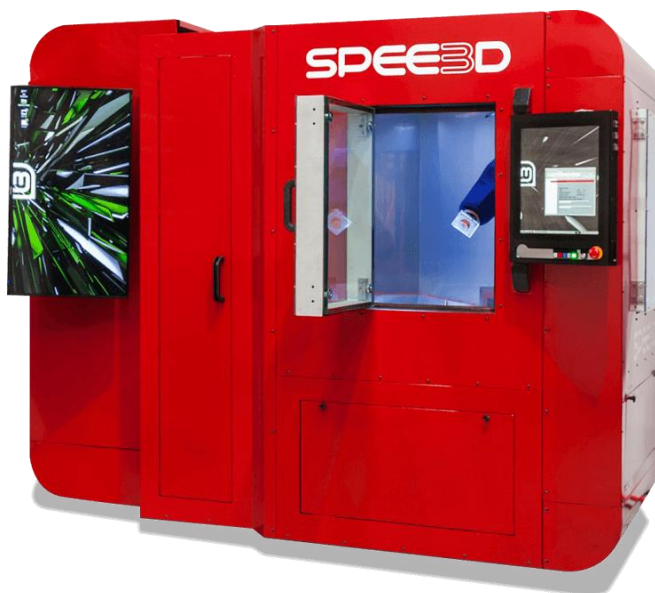
Слика 4.11 WarpSPEE3D штампач [12]
