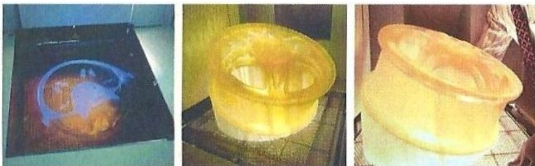
Слика 2.3 Поступак израде дела SLA методом и коначан изглед дела [5]
