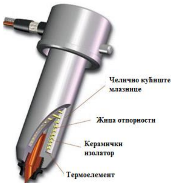
Слика 4.5. Топла дизна
