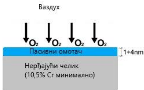
Слика 1.1 Формирање пасивног омотача нерђајућег челика са атмосфером.
