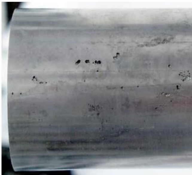
Слика 6.1 Рупичаста корозија на спољашњости цеви.
