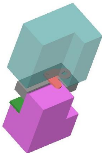
Слика 8.9. Прва операција савијања у програму Simufact.forming
