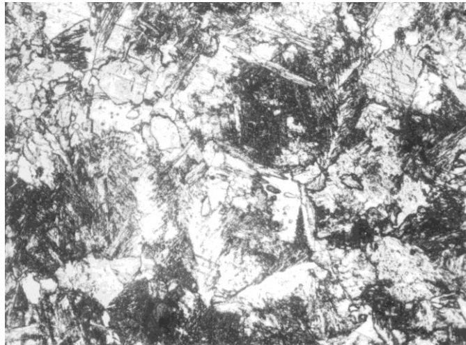
Слика 5.19 Микроструктура ЗУТ-а – s = 1.2 \text{ mm} (200×)
