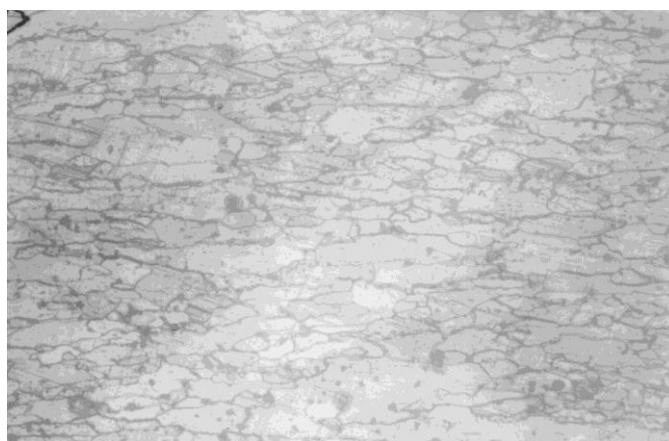
(Ситнозрна, претежно феритна структура са незнатним учешћем перлита) Слика 5.18 Микроструктура ОМ – s = 1.2 \text{ mm} (200 \times )
