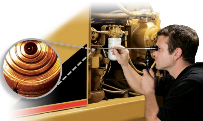
Слика 4.1 Бороскоп, уређај који се понекад користи за визуелну контролу
