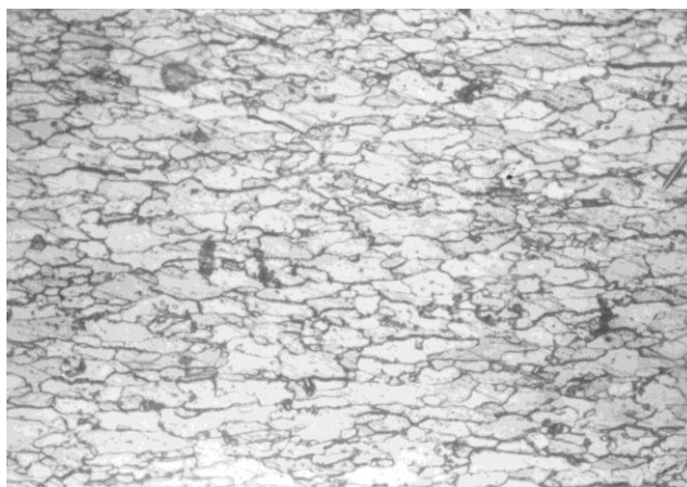
Слика 5.15 Микроструктура OM – s = 0.8 \text{ mm} (200×)
