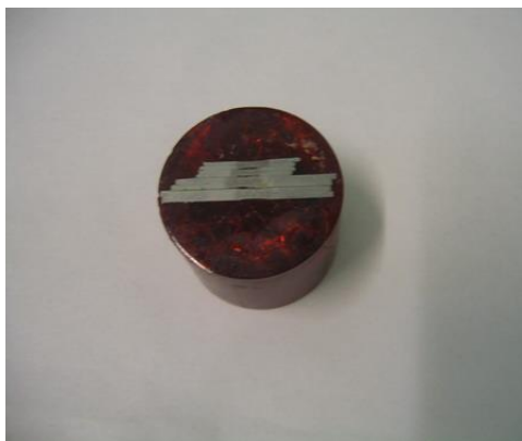
Слика 5.13 Изглед затопљених металографских избрусака
