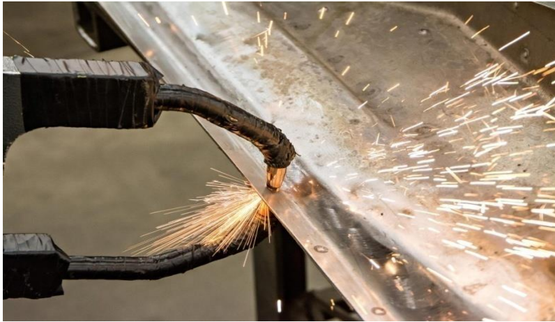
Слика 3.4 Тачкасто заваривање каросеријског лима
