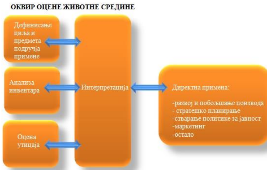
Слика 4- Фазе LCA
