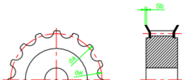
Слика 2.5: Изглед каишника са карактеристичним димензијама, d_a mm – спољашњи пречник каишника, d_w mm- подеони пречник каишника, S_b mm – дебљина обода каишника [8]
