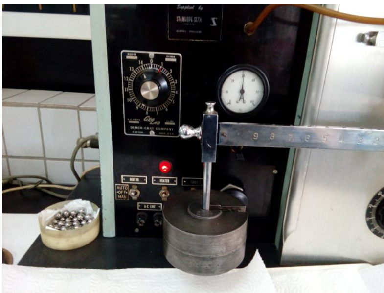
Слика 28. Подешавање оптерећења и дужина трајања испитивања
