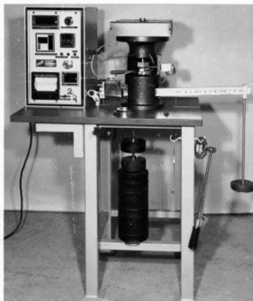
Слика 14. Four-ball машина за EP тест
