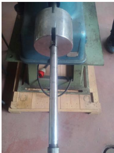
Слика 33. Полуга и тег за подешавање оптерећења
