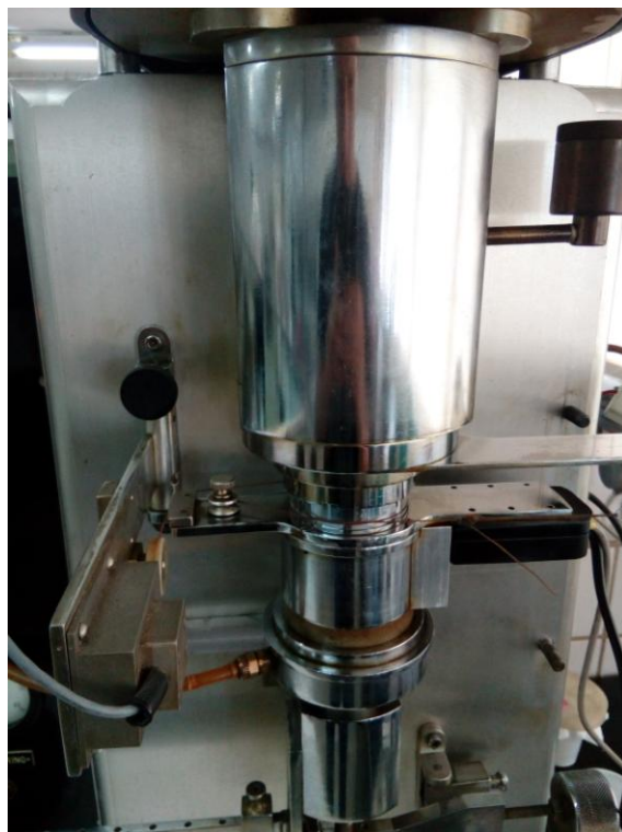
Слика 29. Посуда за испитивање постављена на уређај
