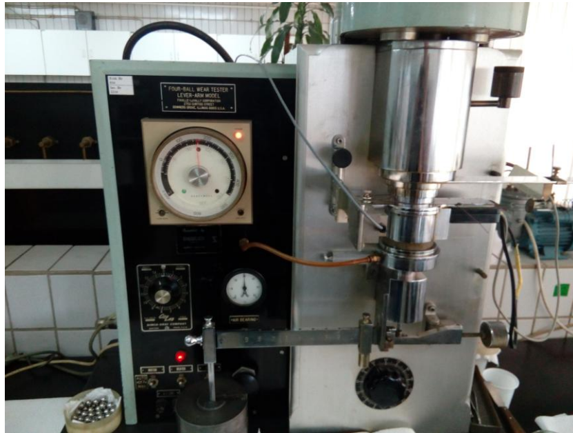
Слика 19. Уређај за испитивање мазива са четири куглице
