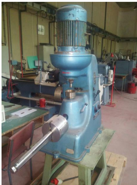
Слика 31. Four-ball RANZI U.M. 112
