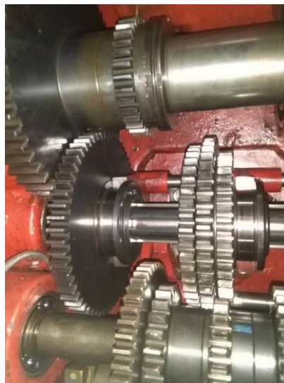
Слика 7. Приказ зубчастог преносника код машина алатки
