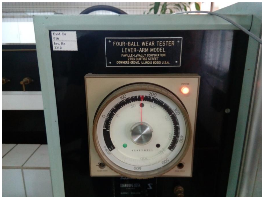
Слика 27. Температура на којој се врши испитивањ
