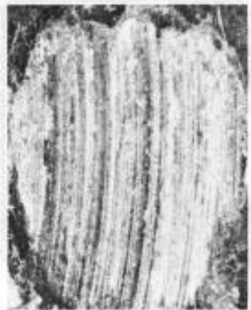
Слика 18. Типични тестни ожилци кугле – након уклањања
