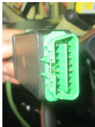
Слика 8.15. – Конектори преко којих се остварује комуникација [12]
