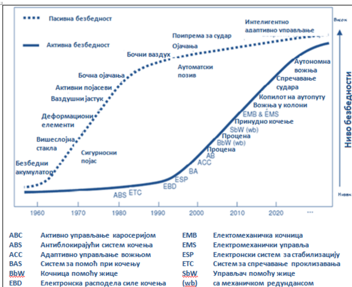
Слика 2.2. – Тенденције развоја активне и пасивне безбедности [5]
