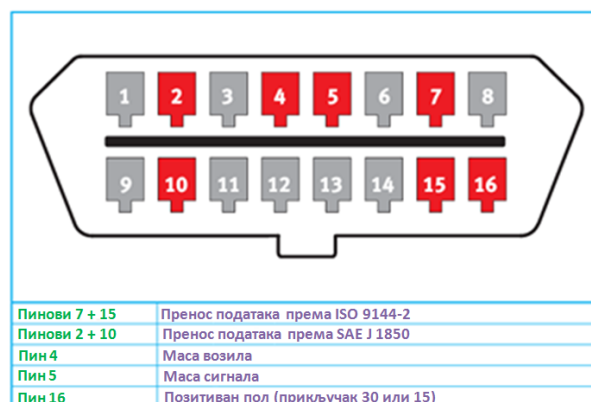
Слика 6.7. - Дијагностички конектор са ознакама контаката (пинова) [11]
