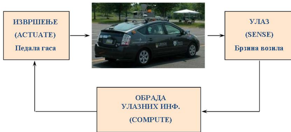
Слика 2.5. – Илустрација принципа рада електронског управљачког система на возилу [5]
