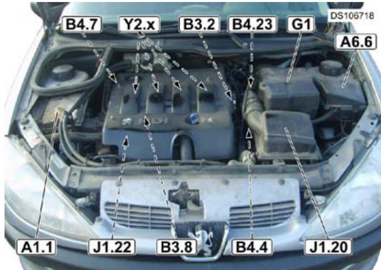
Слика 7.12. - Распоред компоненти у моторском простору (A 1.1=ECU мотора, J1.22= Пумпа високог притиска (PVP), B3.8= Давач температуре горива, B4.4= Давач броја обртаја коленастог вратила са референтом ознаком, B4.7= Давач позиције брегастог вратила, Y2.x= Бризгаљке, итд.) [13]
