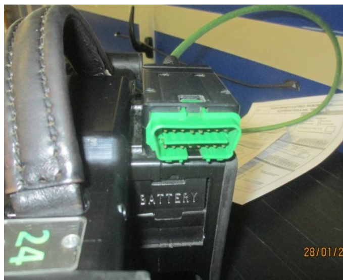
Слика 8.15. – Конектори преко којих се остварује комуникација [12]
