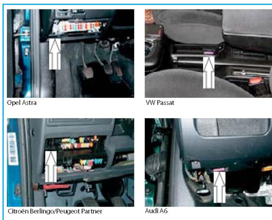
Слика 6.8. - Примери локација дијагностичког прикључка [13]
