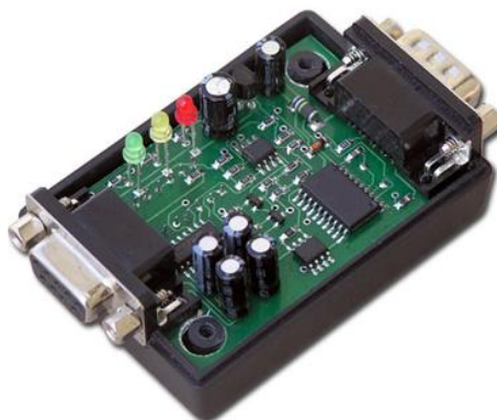
Слика 7.1. - VISA уређај за дијагностику [14]
