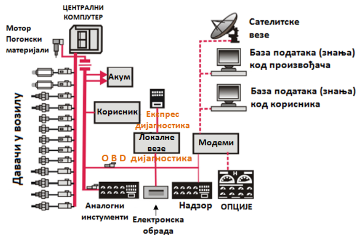
Слика 6.13. - Прва генерација флексибилних сервисних система на возилу [11]
