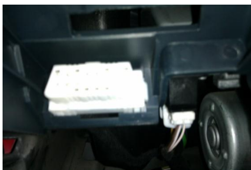
Слика 8.5: OBD прикључак на возилу [15]
