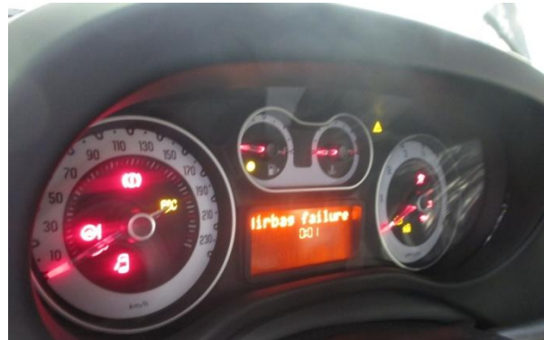
Слика 6.4. – Пример поруке о грешци на инструмент табли [12]
