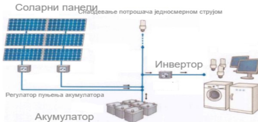
Слика 17. Шематски приказ фотонапонског система за снабдевање потрошача електричном енергијом који нису повезани на електродистрибутивну мрежу[26]
