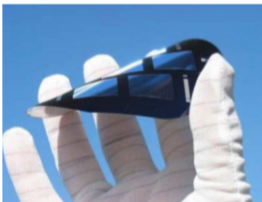
Слика 13. Аморфна фотонапонска ћелија [21]
