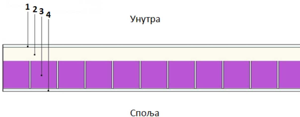
Слика 17 Приказ склопа унутрашње изолације стиропором
