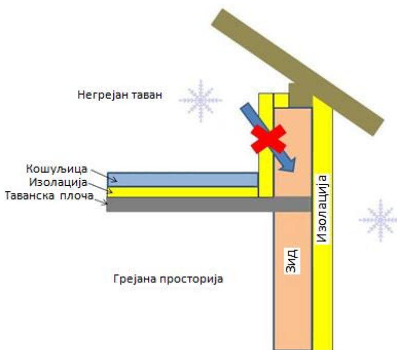
Слика 15 Елиминација топлотног моста код тавана [9]
