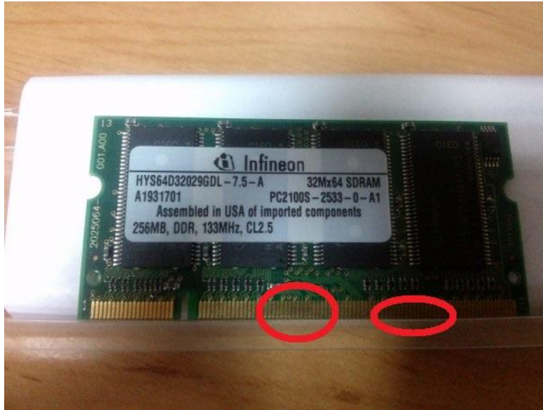
Слика 10. Пример оксидираних контаката на RAM меморији
