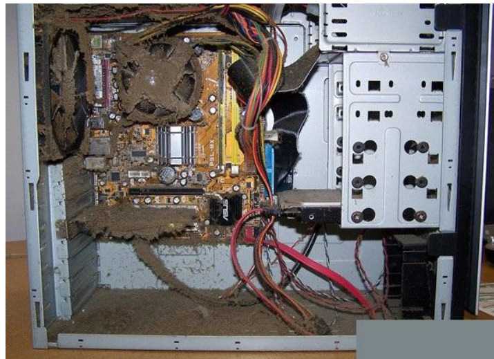
Слика 7. Пример задрљаности унутрашњости кућишта рачунара прашином
