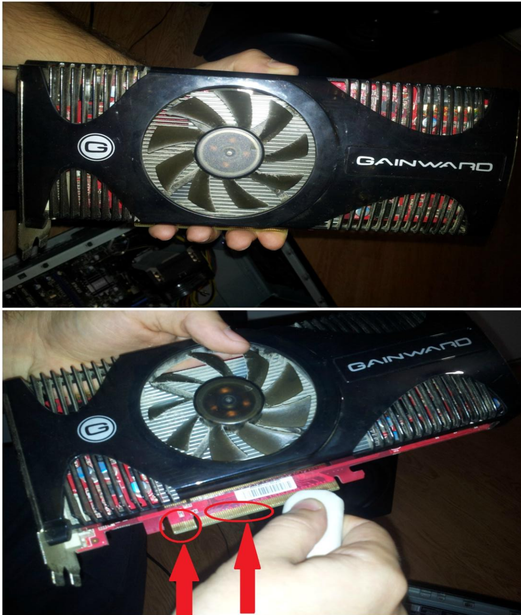
Слике 15. и 16. Пример очишћеног вентилатора и хладњака на графичкој картици (горе). Пример чишћења оксидираних контаката графичке картице (доле)
