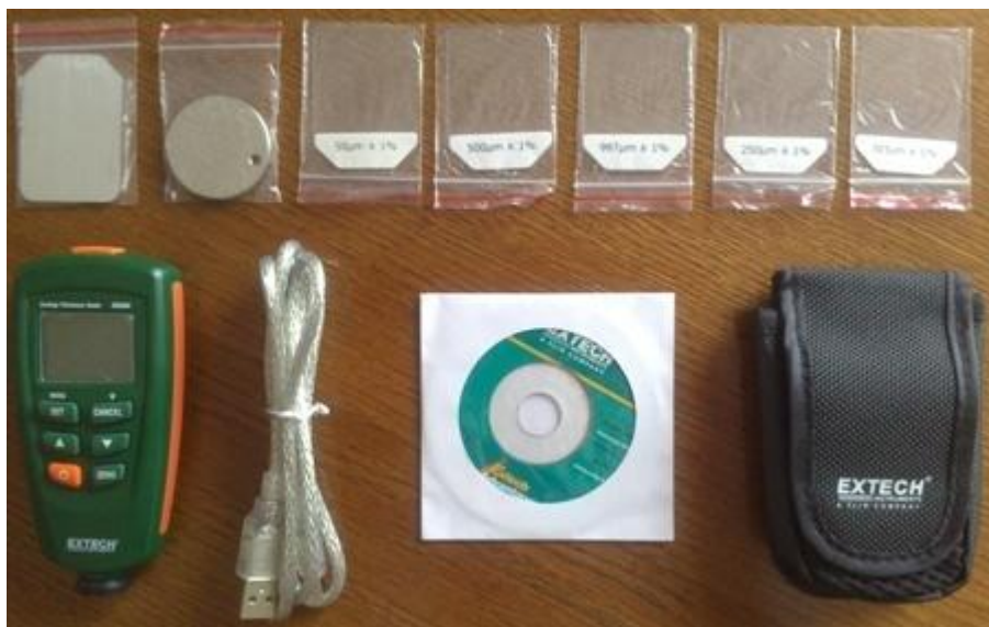
Слика 13. Мерач EXTECH CG204 са пратећом опремом
