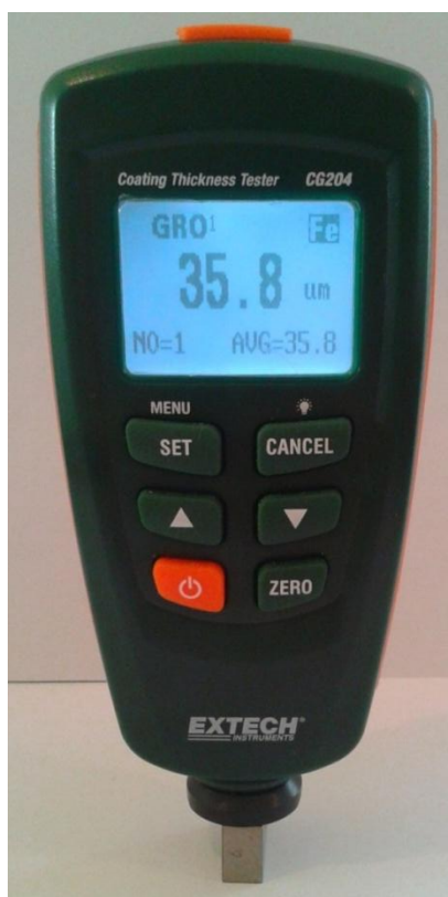
Слика 23. Мерење дебљине превлаке на поцинкованој плочици број 4
