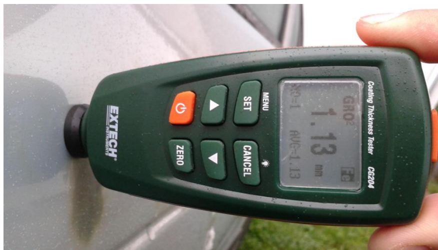
Слика 25. Мерење дебљине превлака на аутомобилу
