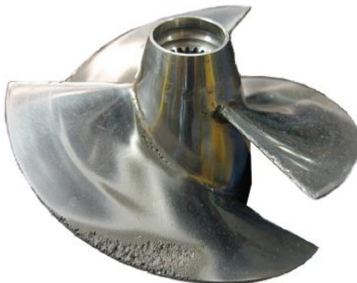
Слика 9. Типична кавитацијска оштећења ротора центрифугалних пумпи [2]
