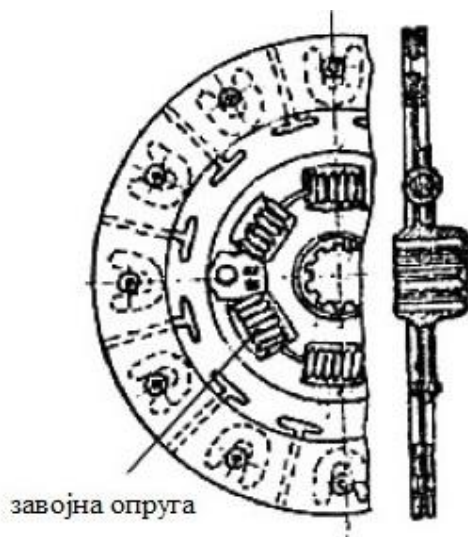
Слика 1.6. Еластична ламела са пригушивачем [1]
