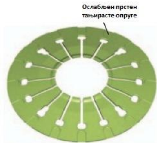
Слика 4.14. Ослабљен прстен тањирасте опруге
