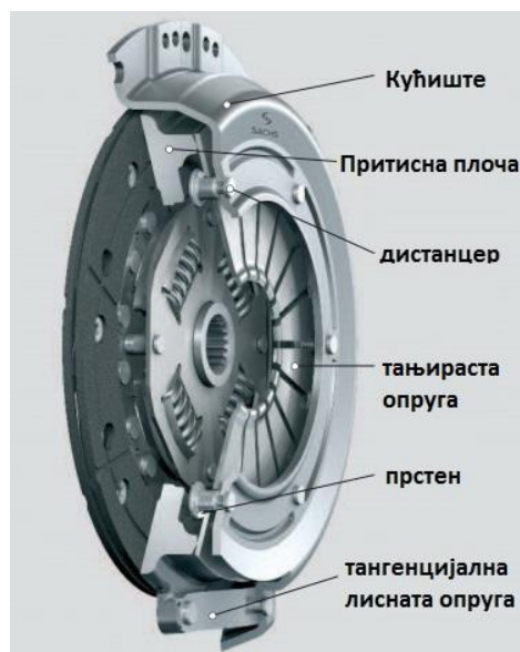
Слика 2.5. Спојница с тањирастом опругом, тип М
