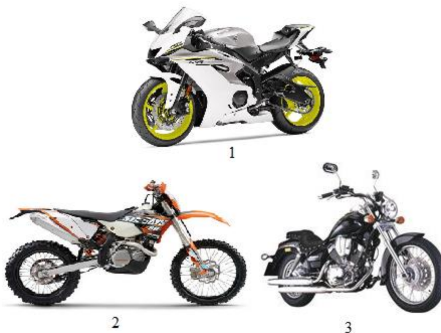
Слика 2.2 Разлике у облику између (1) спортског, (2) ендуро- крос и (3) чофер моторцикла[6]
