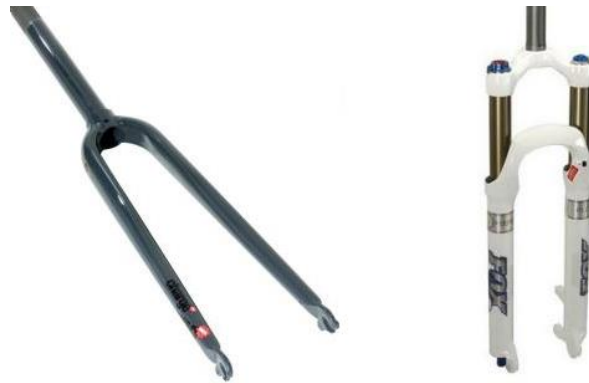
Слика 3.6 Пример круте и виле са амортизером[15]
