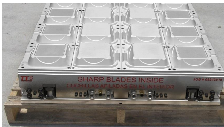
Слика 4.2.1: Пример алата за термообликовање[14]
