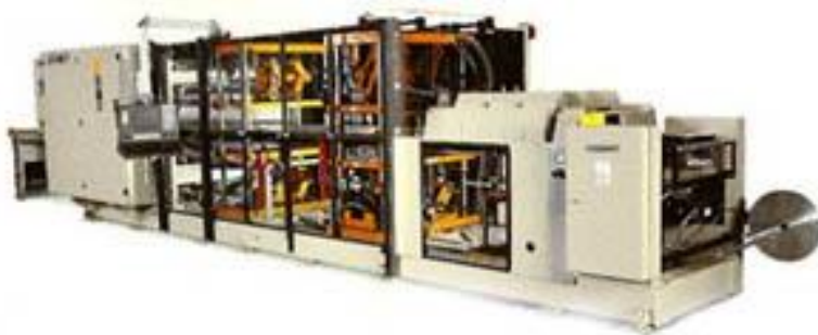
Слика 4.1. Термоформирање са ваљком[8]
