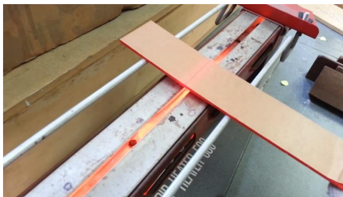
Слика 5.3.1: Пример стрип грејача[23]
