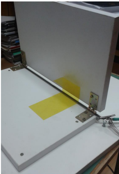
Слика 6.22: Примери савијања делова од акрила дебљине 4 mm и фолије
