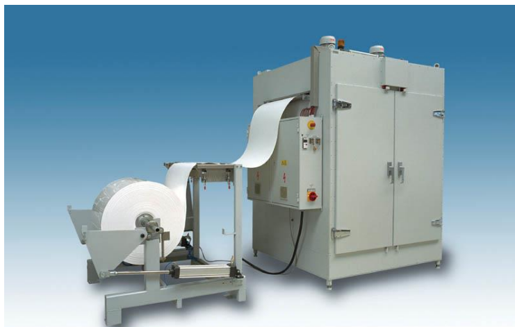
Слика 4.1.1: Спољни изглед предгрејне коморе[9]
