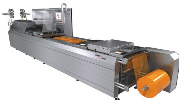
Слика 4.11: Машина за серијску и аутоматску израду делова од фолије из ролне, машина располаже са аутоматским опсецањем готовог производа и намотавањем отпадног материјала[11]
