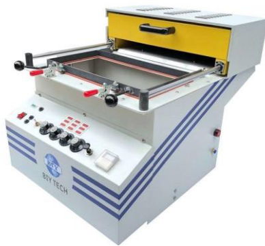
Слика 4.10: Машина за појединачну и малосеријску израду делова од фолије сечених формата, формата А3, на посебној машини се врши опсецање[11]
