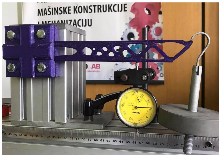
Слика 54. Оптимизована епрувета са испуном 100%
