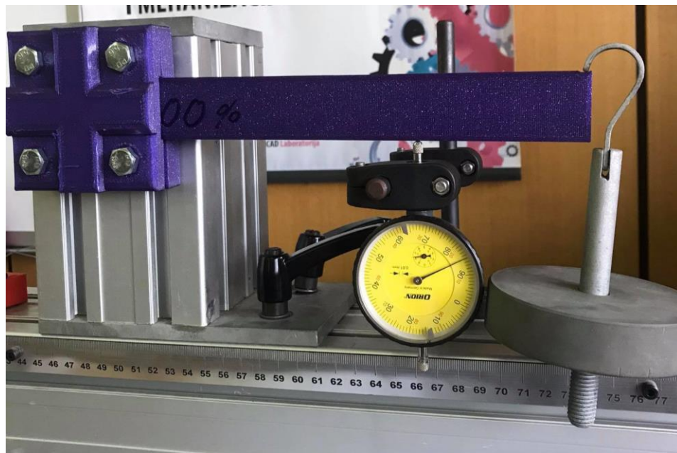
Слика 53. Епрувета са испуном 100% и вертикалном оријентацијом слојева
