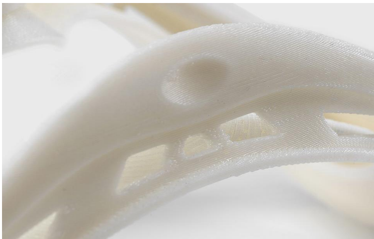
Слика 14. Квалитет површине FDM штампе [7]
