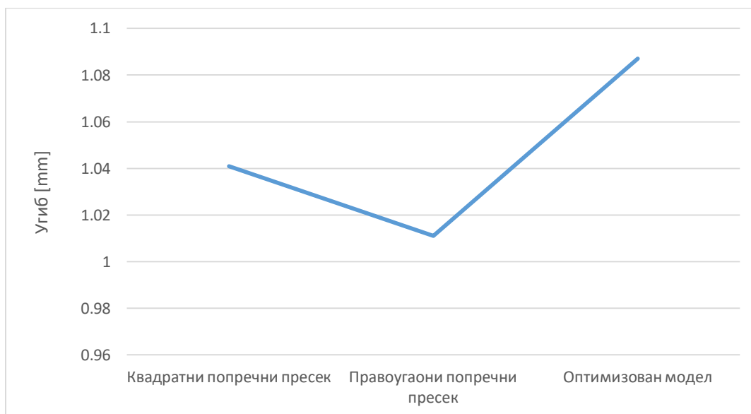
Слика 60. Зависност деформације од врсте попречног пресека
