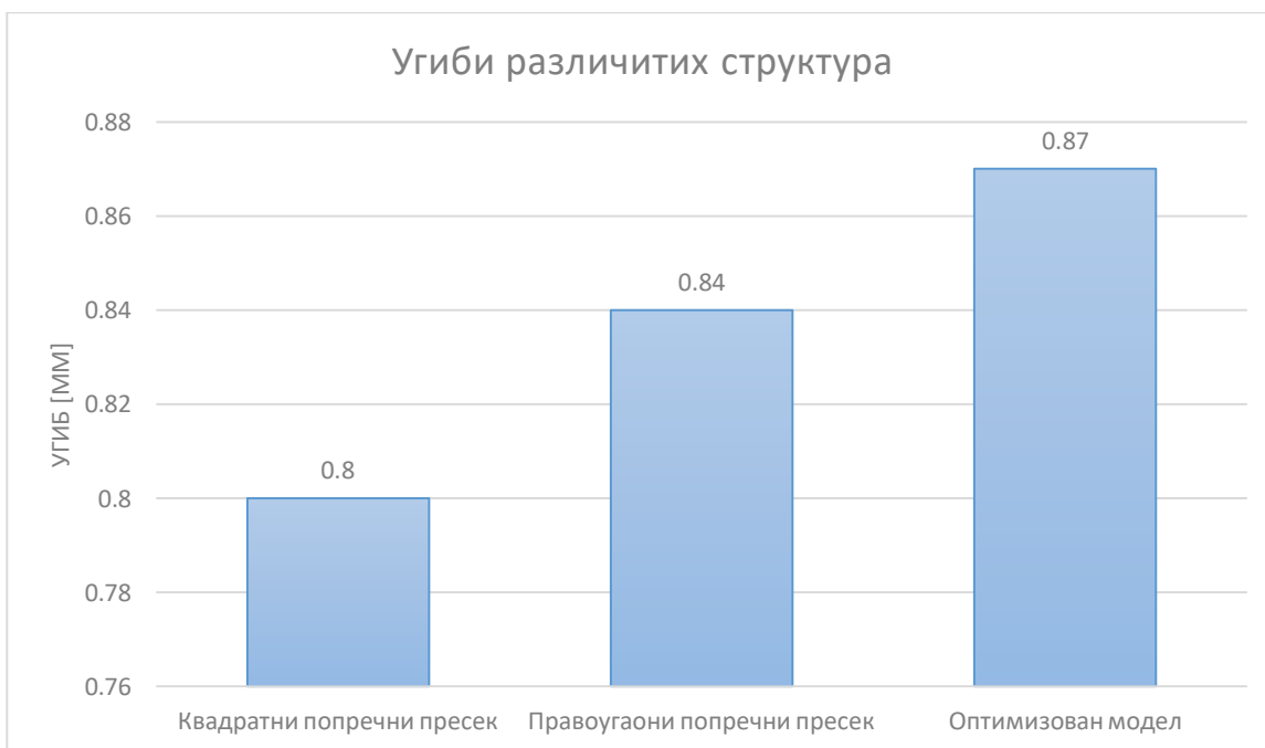
Слика 59. Зависност деформације од структуре
