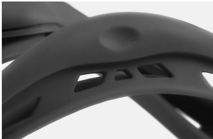
Слика 6. Квалитет површине SLA штампе [7]
