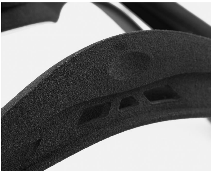
Слика 11. Квалитет површине SLS штампне [7]
