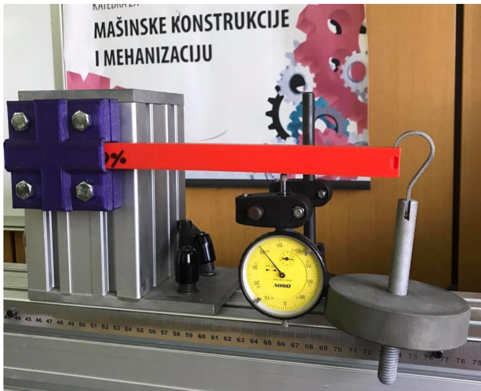
Слика 48. Епрувета са испутом 30% и хоризонталном оријентацијом слојева
