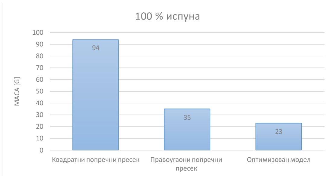
Слика 58. Зависност масе од врсте попречног пресека
