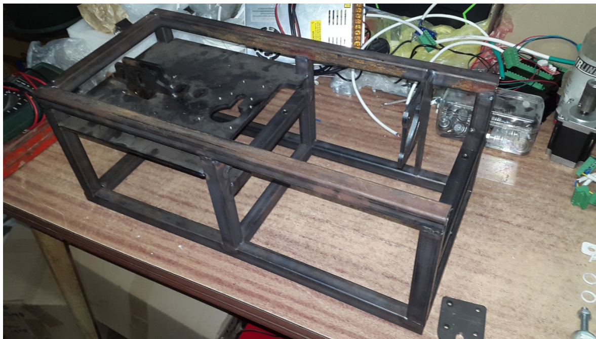
Слика 8. Израђен рам машине од челичних профила
