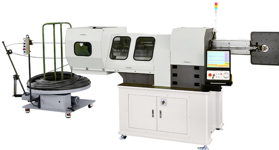
Слика 1. Индустријска ЦНЦ машина за савијање жице марке "Nisemach 3D-R70" [9]
