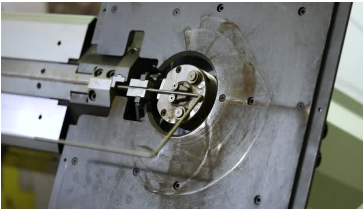
Слика 2. Радно постоље на индустријској машини за савијање жице [9]
