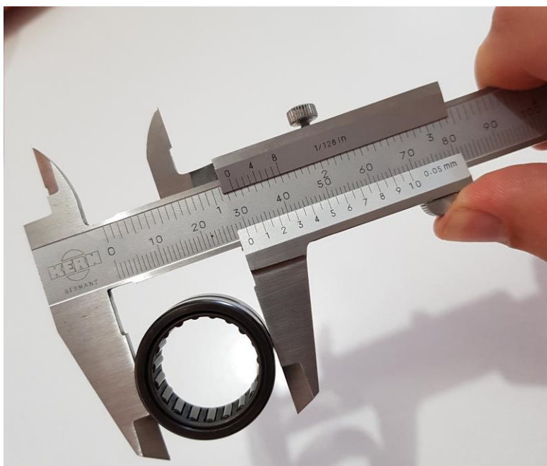
Слика 28. Мерење спољашњих величина код помичног кљунастог мерила [14]
