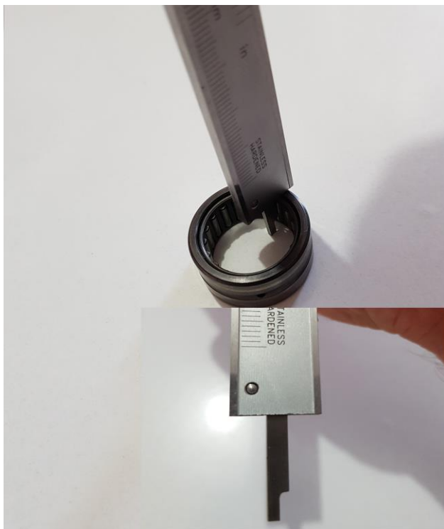
Слика 30. Мерење дубине код помичног кљунастог мерила [14]
