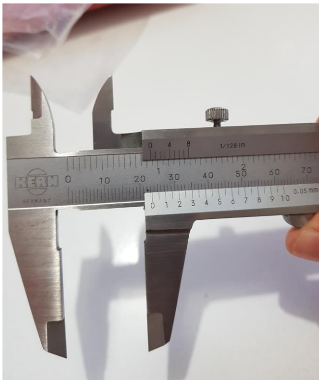
Слика 33. Очитавање вредности код помичног кљунастог мерила [14]
