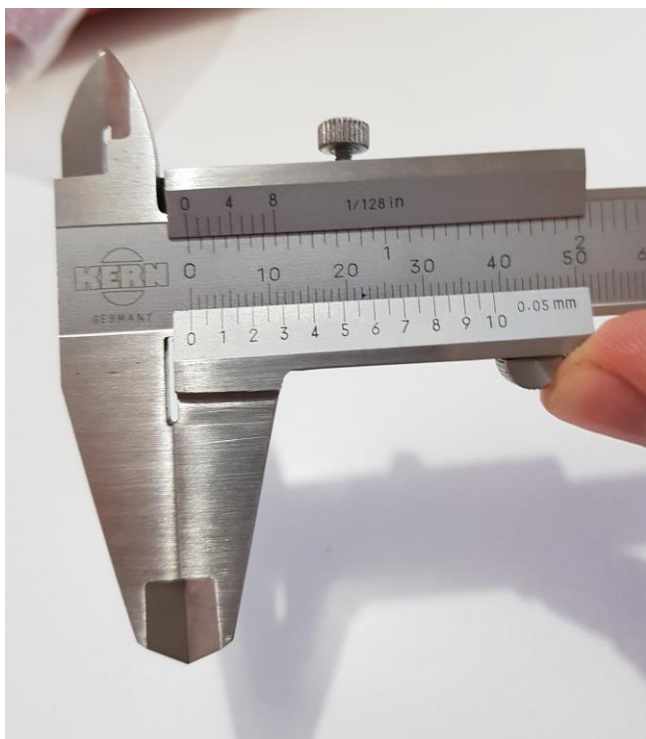
Слика 32. Нулирање код помичног кљунастог мерила [14]
