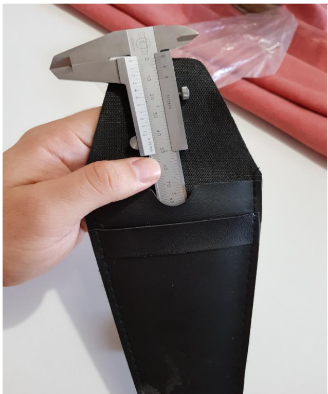
Слика 34. Чување помичног кљунастог мерила [14]
