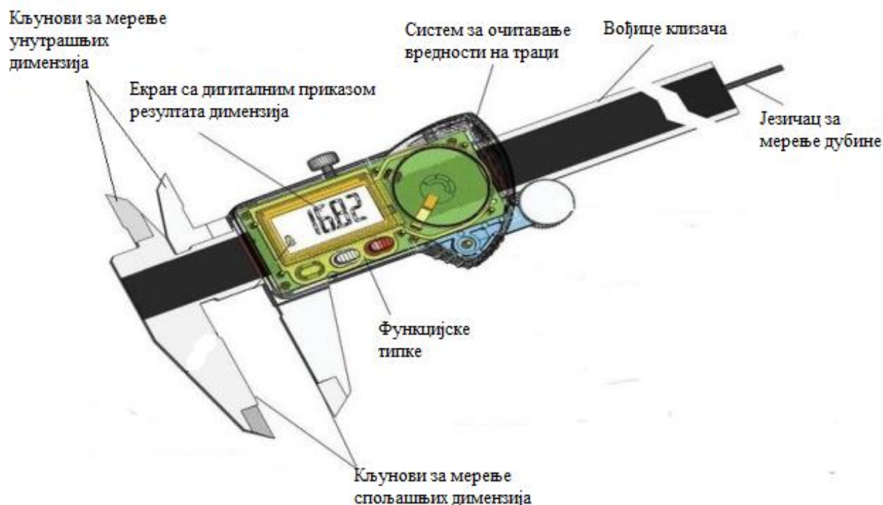
Слика 8. Шематски приказ дигиталног помичног кљунастог мерила [8]
