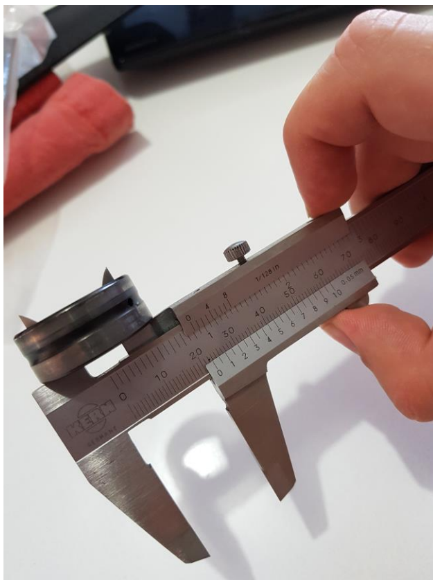
Слика 29. Мерење унутрашњих величина код помичног кљунастог мерила [14]
