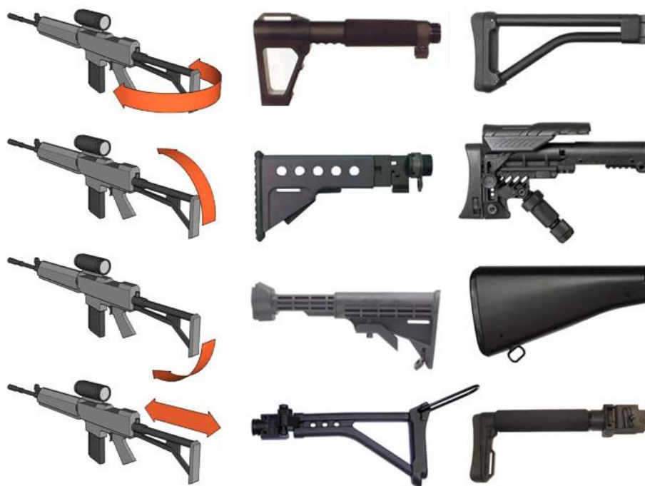
Слика 7.1. Приказ могућих решења склапања и расклапања кундака, као и приказ конструкцијских решења таквих кундака [11]
