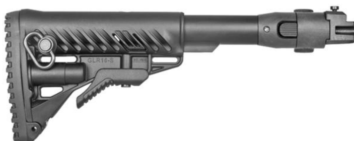
Слика 7.2. Приказ телескопског кундака – типа М-4 (могућност подешавања по хоризонтали, са четири дужине развлачења) од полимерске матрице са стакленим влакнама и са опружним апсорбером [12]
