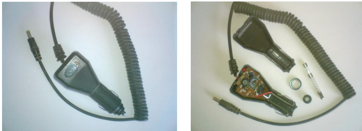
Слика 6.3 Модел утикача 4, у склопљеном (лево) и расклопљеном (десно) стању
