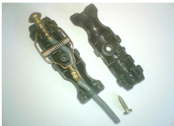
Слика 6.2 Модел утикача 2, у склопљеном (лево) и расклопљеном (десно) стању
