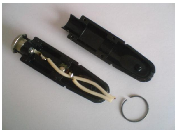
Слика 6.1 Модел утикача 1, у склопљеном (лево) и расклопљеном (десно) стању
