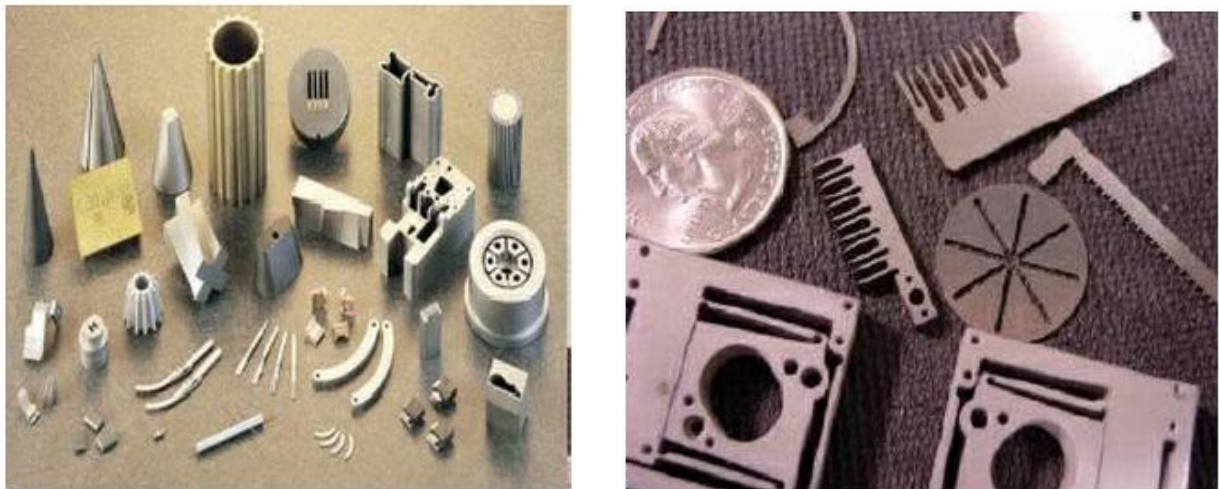
Слика 3.7 Делови добијени електроерозиним резањем жичаном електродом
