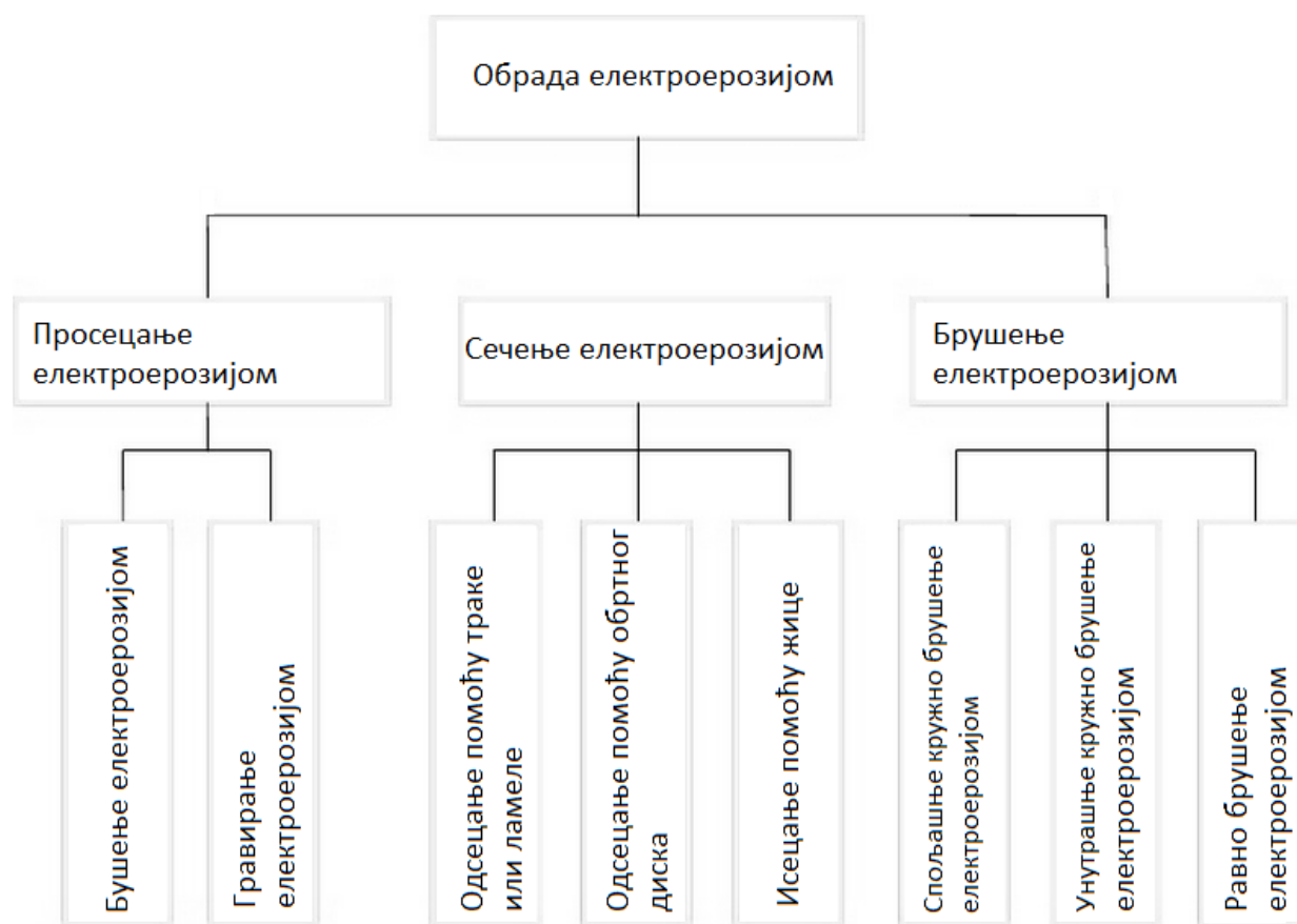
Слика 3.1 Подела производних операција електроерозине обраде [10]
