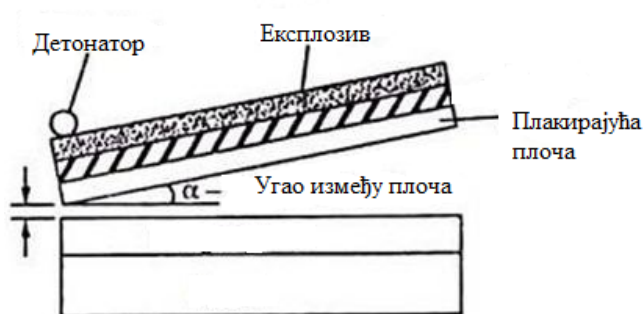
Слика 7. Заваривање под углом [5]
