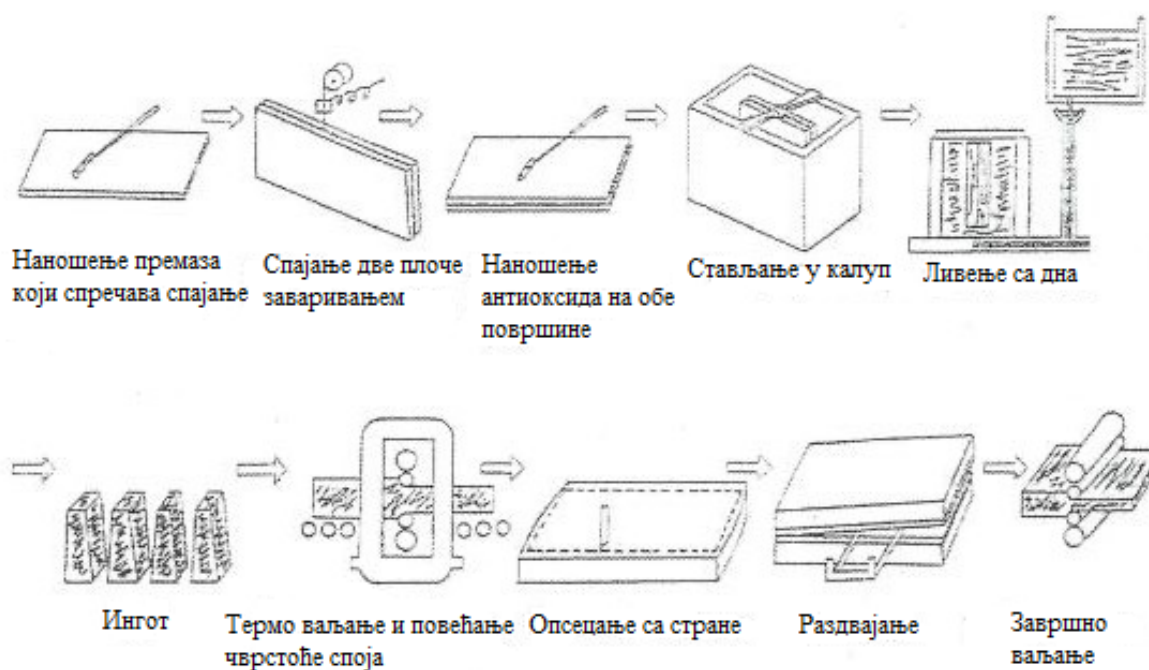
Слика 16. Шема спајања биметала по “КАП” технологији комбинацијом ливења и ваљања [12]
